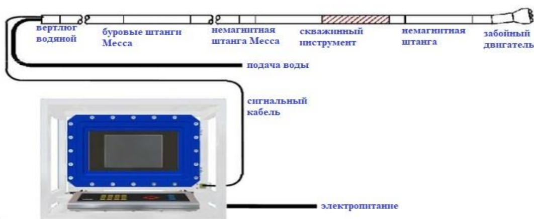
Рисунок 1 – Компоненты системы направленного бурения [2]
