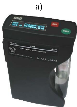
Рисунок 4 - Прибор ПКП: а) внешний вид; б) техническая характеристика
