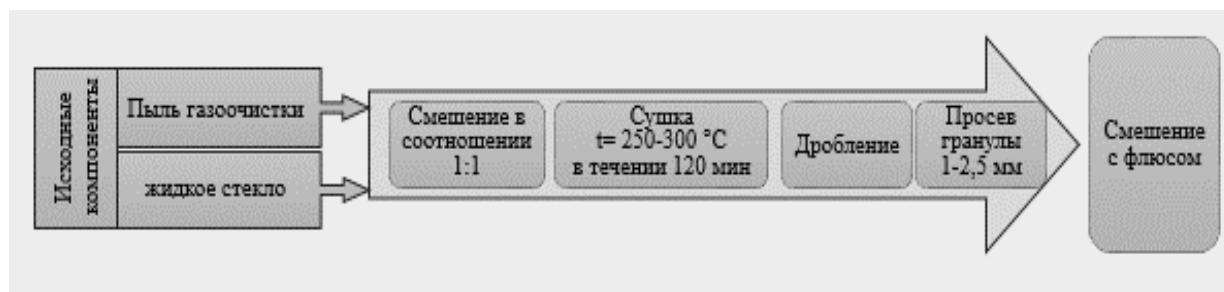
Рисунок 2 – Схема изготовления флюс-добавки на основе пыли газоочистки алюминиевого производства (углеродфторсодержащая добавка)
