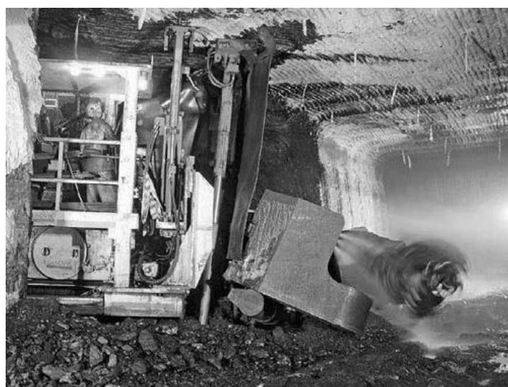
Рисунок 3 – Система пылеподавления на комбайне фирмы SANDVIK
