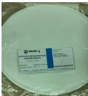
Рисунок 3- а) фильтры обеззоленные ЭКОС.1; б) добавление буферного раствора пипеткой Мора
