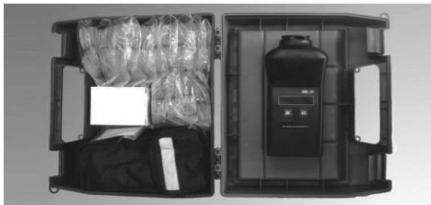
Рисунок 1 - Прибор ПКА-01 контроля запылённости воздуха [6]
