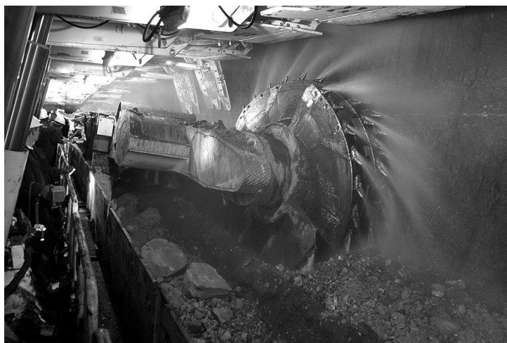
Рисунок 2 - Система орошения на очистном комбайне
