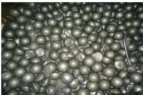
Рисунок 1 – Покол шаров \varnothing 100 мм (около 75 % от шаровой поверхности) в мельнице МШР 3,2×3,1, n = 18 об/мин.
