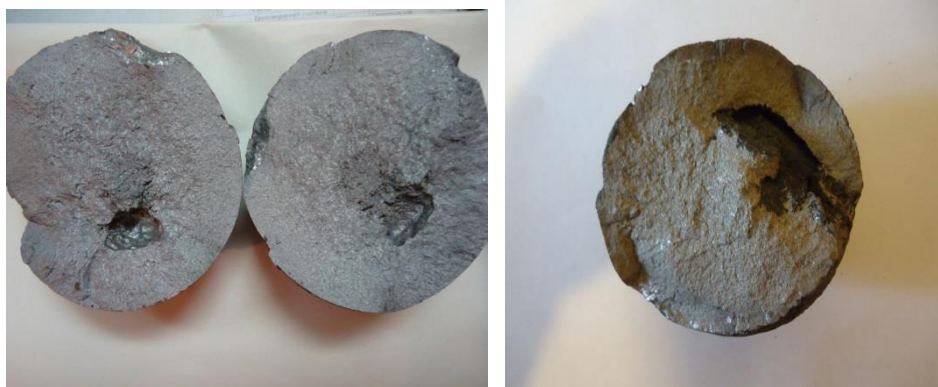
а – газовая раковина, локализуемая в верхней части шара; б – усадочная раковина в верхней половине шара Рисунок 3 – Литейные дефекты в литых шарах
