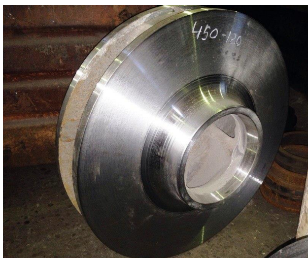
Рисунок 4 – Ответственная отливка (колесо рабочее) без газовых раковин
