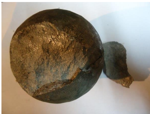
Рисунок 4 – Трещины на поверхности шара, ведущие к расколу и отслоению поверхности
