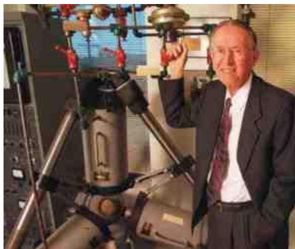
Трейси Холл рядом со своей первой тетраэдрической установкой для синтеза алмаза, ноябрь 1999 г.
