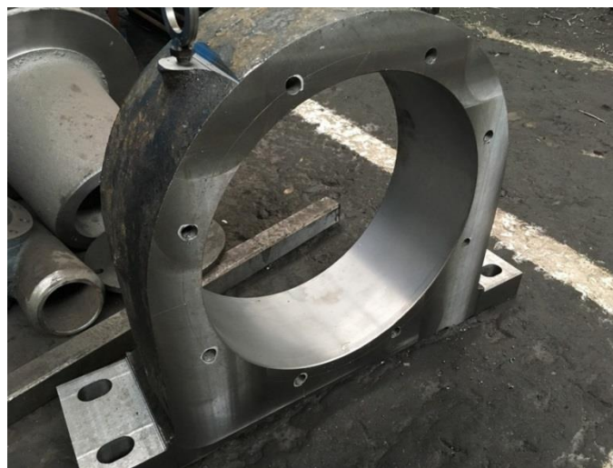
Рисунок 3 – Отливка (корпус подшипника) с эффективным раскислением металла и термовременной обработкой
