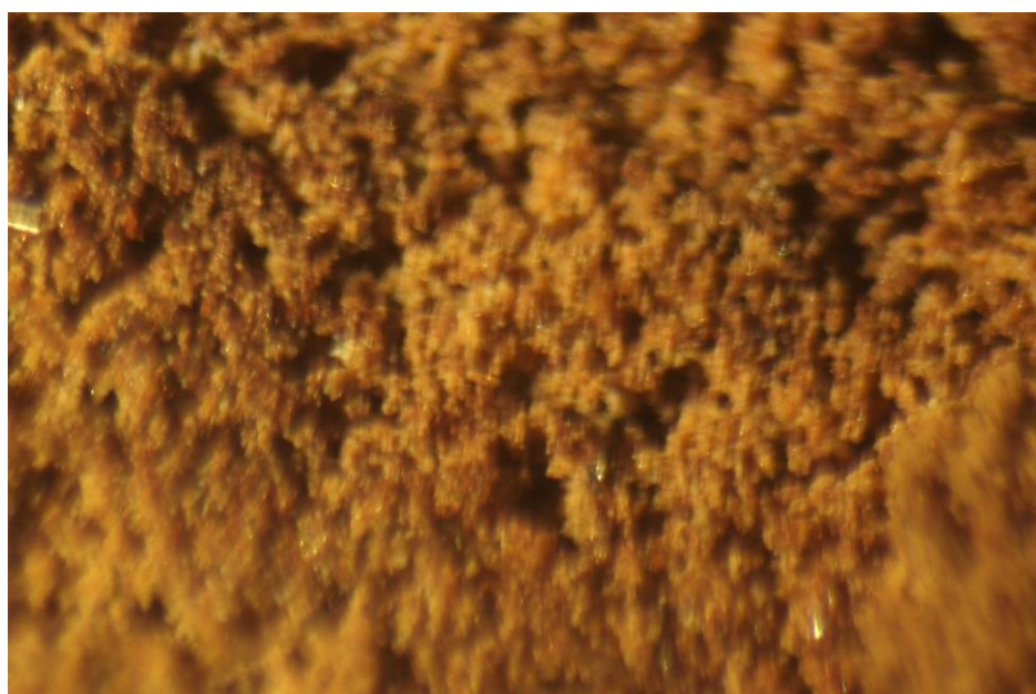
Рисунок 3 – Дендритная структура окалина, \times 40
