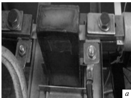
Рис. 2. Внешний вид разрывной машины ИР 5047-50-10 и испытуемый образец внутри волновода (а) и фрагмент диаграммы (б) деформирования образца со скачками напряжений при действии импульсов тока (1, 3), тока и СВЧ-излучения (2, 4) в условиях активной деформации при величине скачков напряжений: 1 – 14,0 МПа; 2 – 14,8 МПа; 3 – 14,3 МПа; 4 – 15,0 МПа
