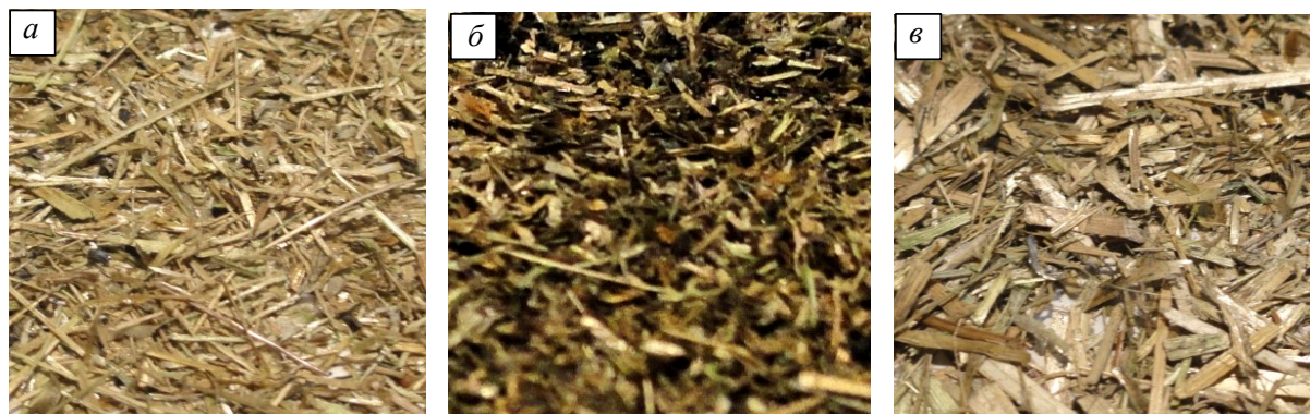
Рис. 2. Внешний вид частиц, полученных измельчением на дисковой мельнице, размером 0,1 – 0,4 мм (а), 0,4 – 0,6 мм (б) и 0,6 – 1,0 мм (в)
