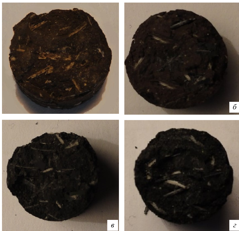
Рис. 7. Макроструктура излома брикетов после сушки при t_0 = 100 °C (а, в) и высокотемпературного обжига при t_0 = 500 °C (б, г) (количество ПД РП 2 %):
