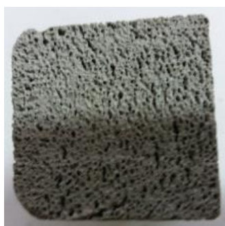
Рисунок 2 – Макроструктура образцов неавтоклавного газобетона (состав 2- зола+известняк-ракушечник + Glenium)
