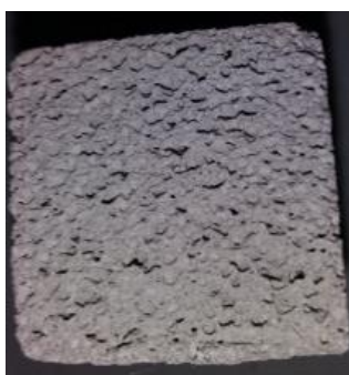
Рисунок 1 – Макроструктура образцов неавтоклавного газобетона (1 состав - зола+известняк-ракушечник + Melment)
