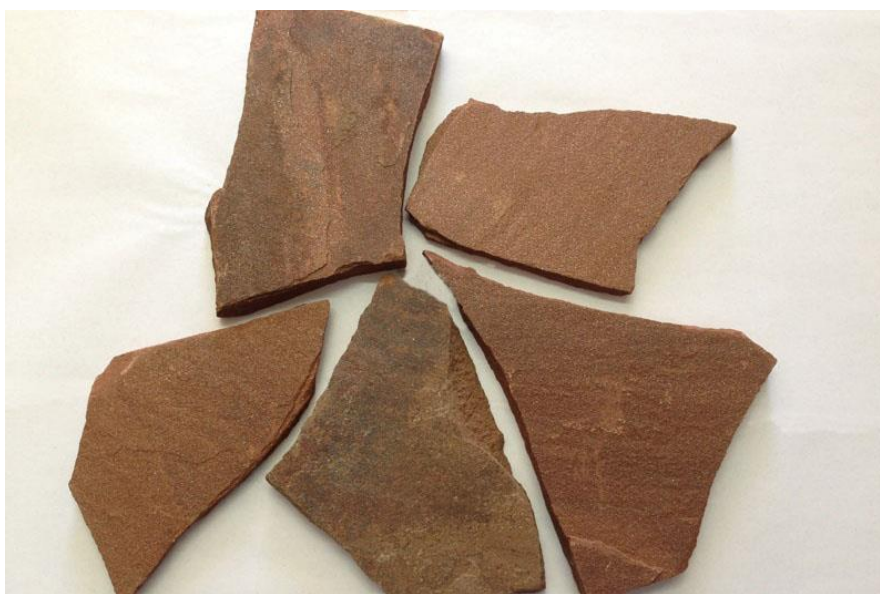
Рисунок 2 – Образцы сланца обожженные
