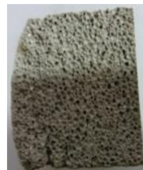
Рисунок 3 – Макроструктура образцов неавтоклавного газобетона (состав 3- известняк-ракушечник + Glenium))
