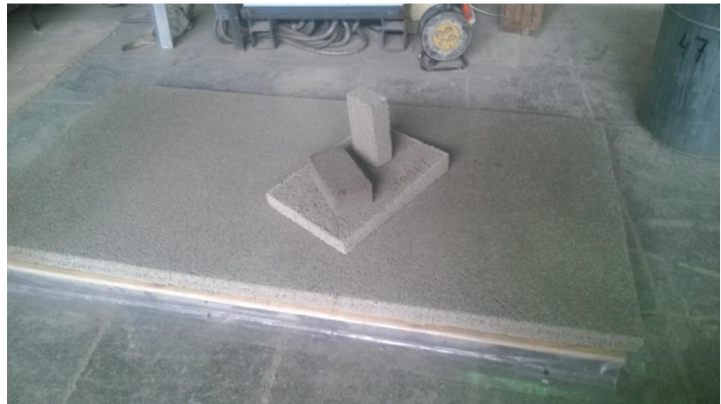
Рисунок 2 – Блоки и плиты 2800×1000×80 мм для звуко- и теплоизоляционных перегородок
