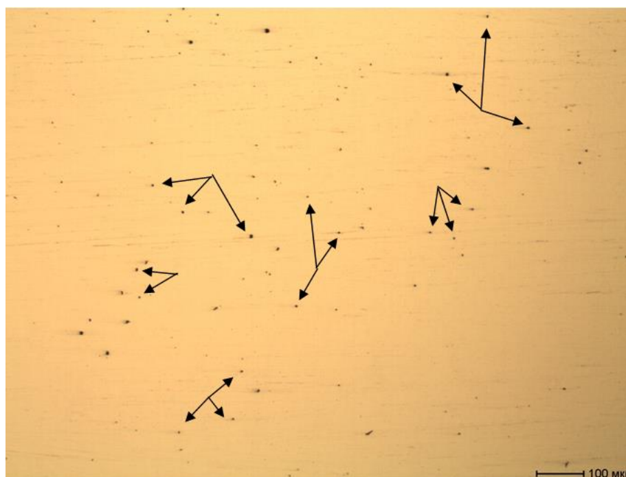
Рисунок 5. Оксиды точечные на заготовках от плавки стали 09Г2С, произведенных по стандартной технологии
