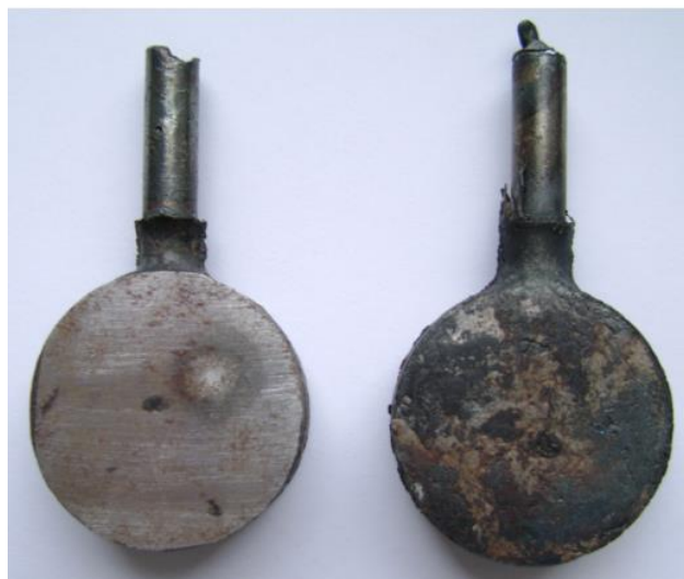
Рисунок 3. Общий вид пробы, полученной пробоотборником «ЕВРАЗСАМП ES»
