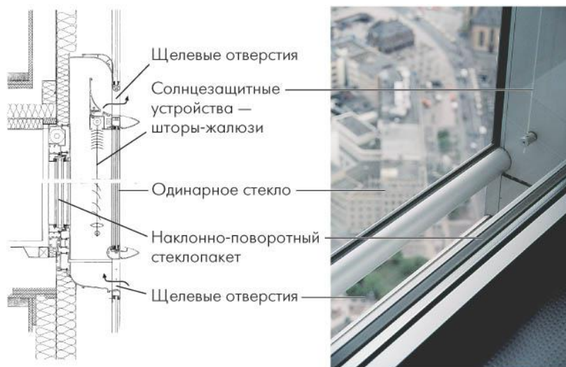
Рисунок 4 - Двухслойный вентилируемый фасад
