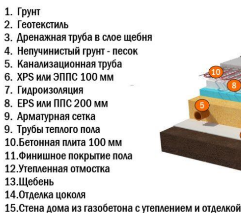
Рисунок 1 - Утепленная шведская плита УШП
