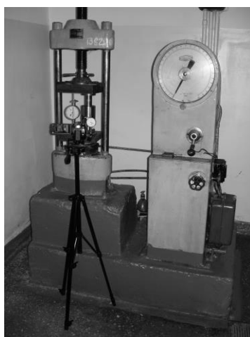
Рисунок 3 – Процесс синхронной фиксации показаний стрелочных индикаторов при прессовании на видеокамеру
