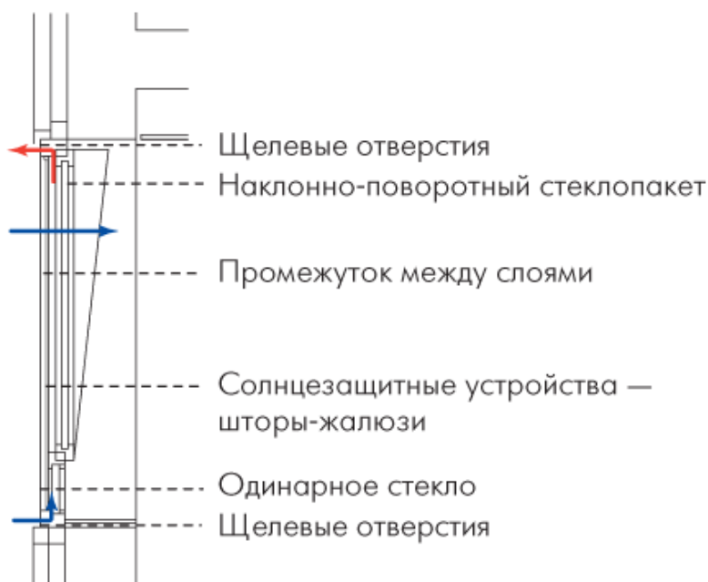
Рисунок 3 - Вариант двухслойного вентилируемого фасада со щелевыми отверстиями
