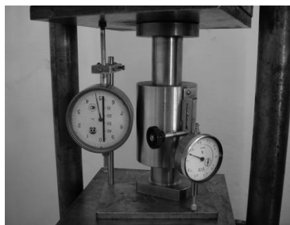
Рисунок 2 – Работа установки под прессом для определения осадки пресс-порошков при двустороннем сжатии
