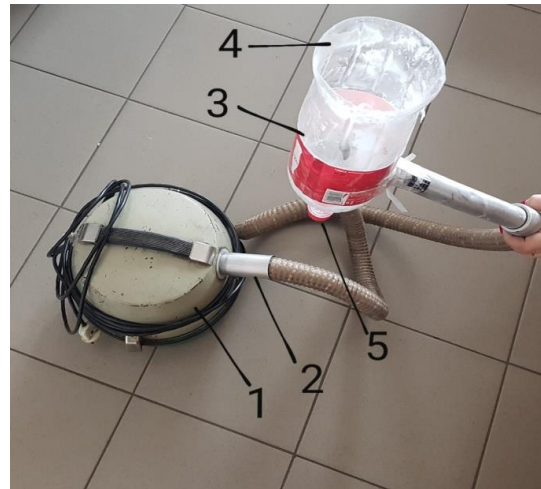
Рисунок 1 – Оборудование по типу скруббер : 1 - корпус; 2- патрубок; 3- бункер; 4- место крепления фильтра; 5- шламонакопитель
