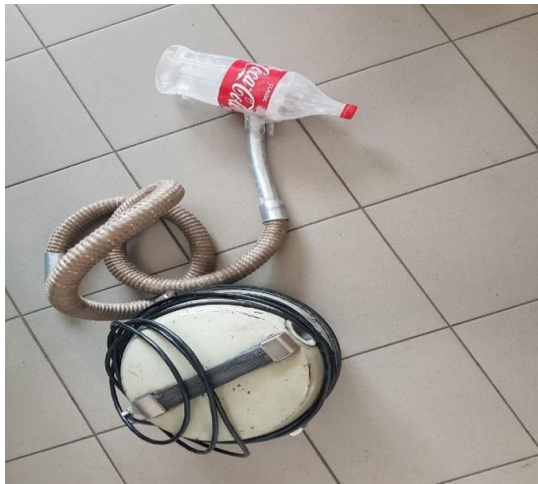
Рисунок 1 – Оборудование по типу скруббер : 1 - корпус; 2- патрубок; 3- бункер; 4- место крепления фильтра; 5- шламонакопитель
