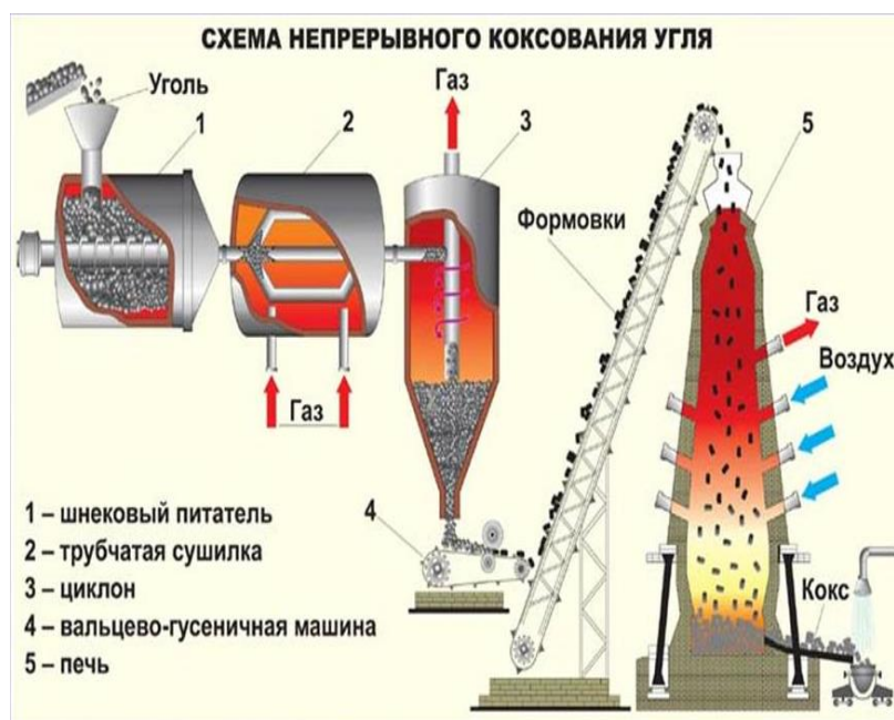
Рисунок 1 - Схема непрерывного коксования угля
