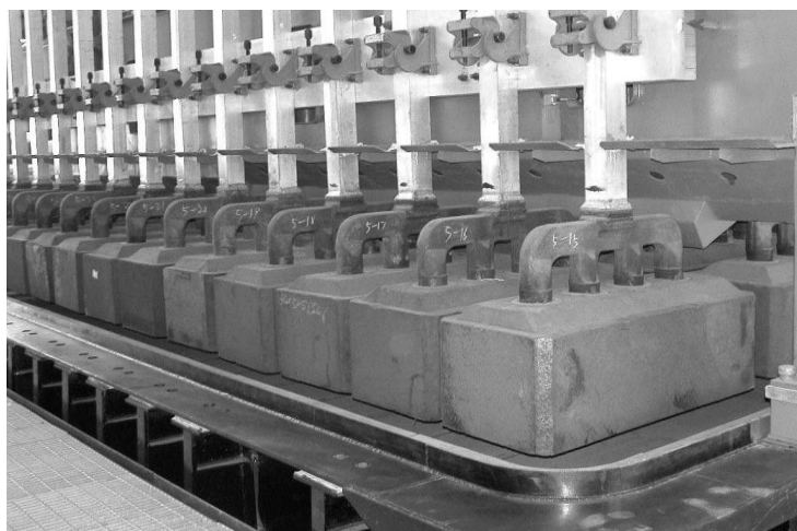
Рисунок 6 – Обожженные аноды в составе анодного устройства алюминиевого электролизера
