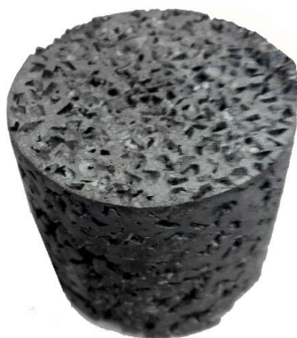
Рисунок 3– Пористая заготовка из маточного сплава для ввода в поры ультра- и наноматериалов
