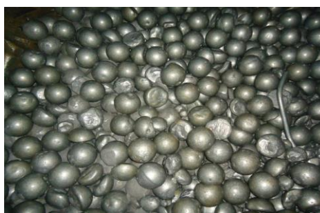
Рисунок 1 - Покол шаров \varnothing 100 мм (около 75% от шаровой поверхности) в мельнице МШР 3,2 \times 3,1, n = 18 об/мин.
