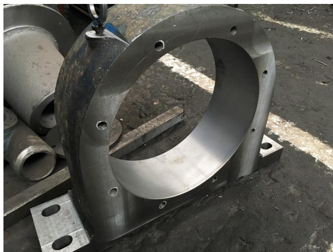
Рисунок 3 - Отливка (корпус подшипника) с эффективным раскислением металла и термовременной обработкой
