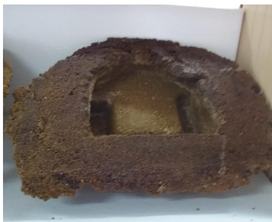
Рисунок 1 – Опытная оболочковая форма
