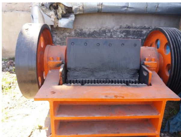
Рисунок 4 – Дробилка УЗТ 4/2 для испытаний плиты
