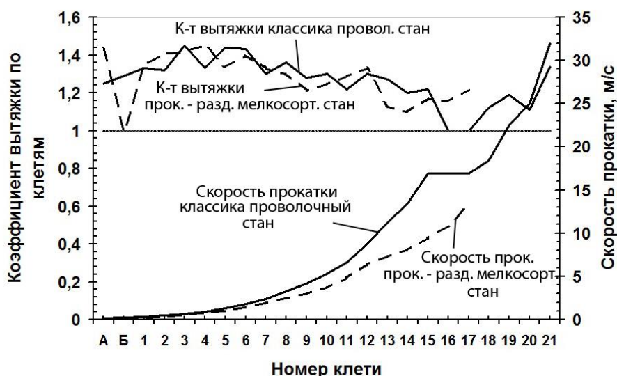
Рисунок 4 – Распределение коэффициентов вытяжки и скоростей по клетям при производстве арматуры №8 классическим способом на проволочном стане и прокаткой-разделением на непрерывном мелкосортном стане 250-1 АО “ЕВРАЗ ЗСМК”
