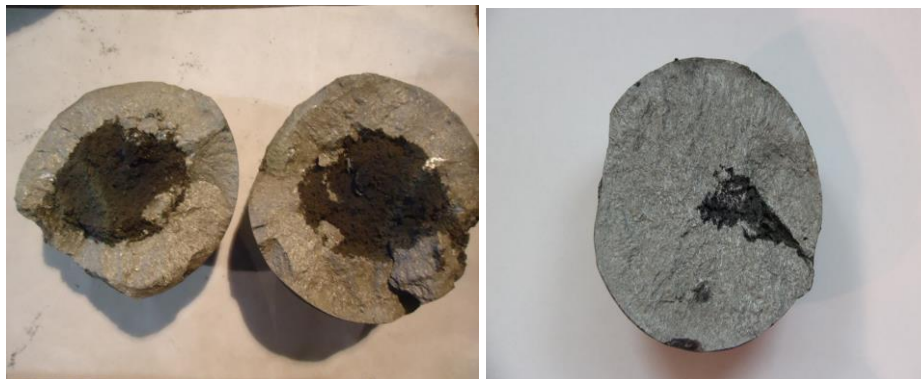
а – в центральной части литого шара; б – рыхлота, идущая от центра к питателю
