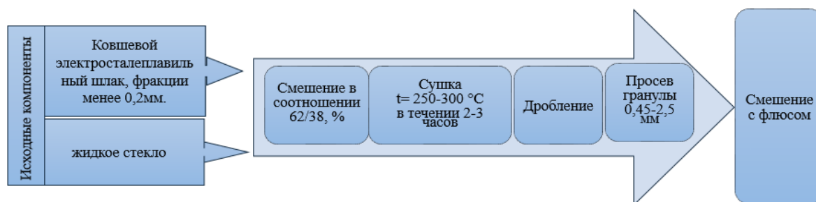
Рисунок 1 – Схема изготовления флюс – добавки
