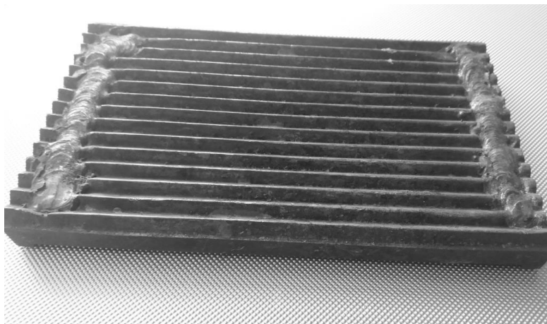
Рисунок 1 – Щековая плита из опытного сплава
