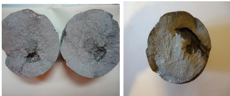
а – газовая раковина, локализуемая в верхней части шара; б – усадочная раковина в верхней половине шара
