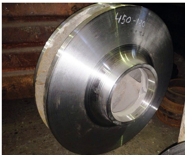
Рисунок 4 - Ответственная отливка (колесо рабочее) без газовых раковин
