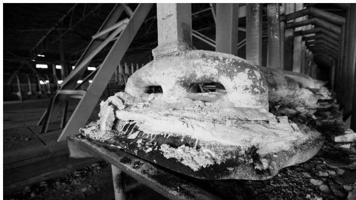
Рисунок 3 – Огарок анода алюминиевого электролизера
