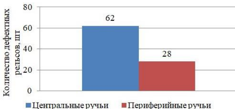
Рисунок 3 – Количество дефектных рельсов в серии (20 плавов) по центральным и периферийным ручьям
