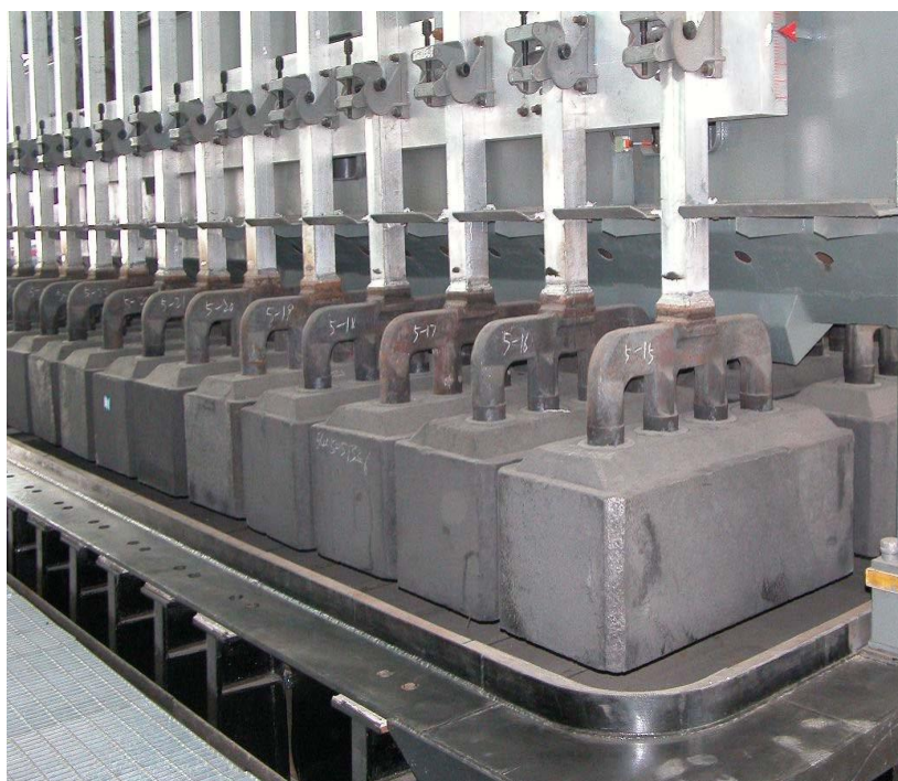
Рисунок 5 – Обожженные аноды в составе анодного устройства алюминиевого электролизера
