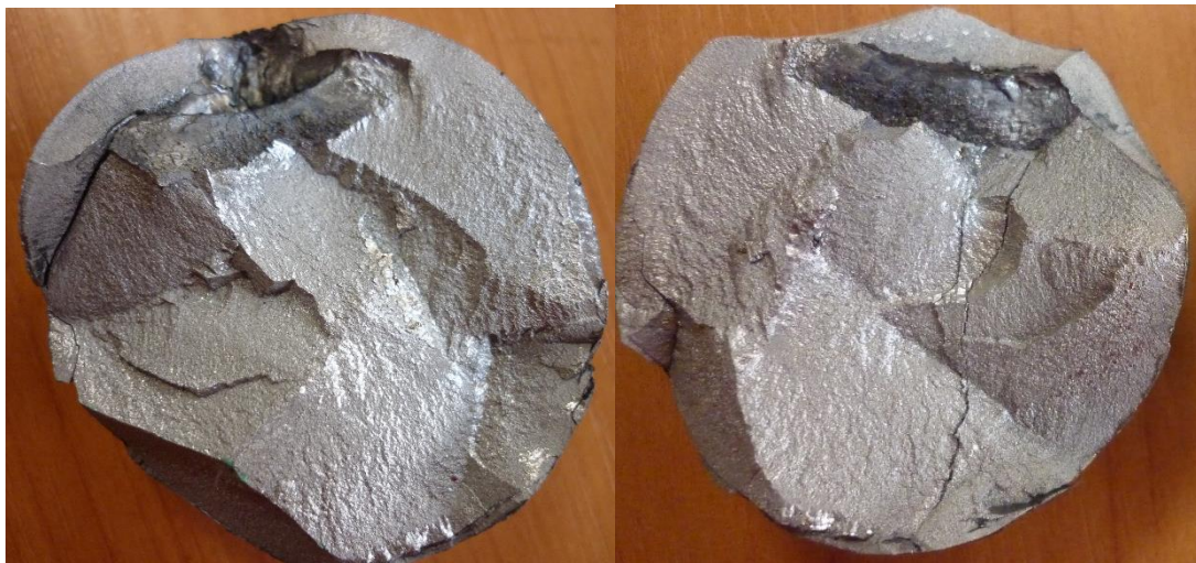
Рисунок 6 – Общий вид изломов шаров, прокатанных из заготовок без дефектов макроструктуры
