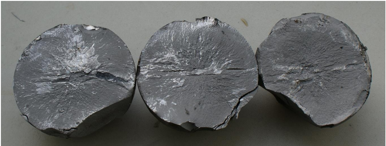
Рисунок 5 – Общий вид изломов шаров, прокатанных из заготовок с флокенами
