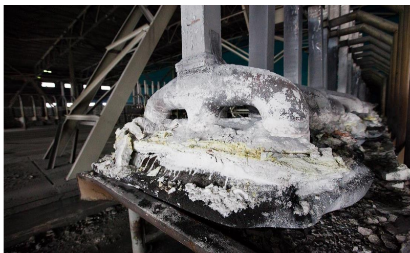
Рисунок 3 – Огарок анода алюминиевого электролизера
