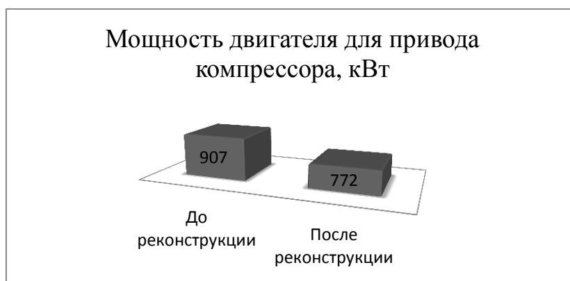
Рисунок 3 – Расчетное значение мощности двигателя для привода компрессора до и после реконструкции
