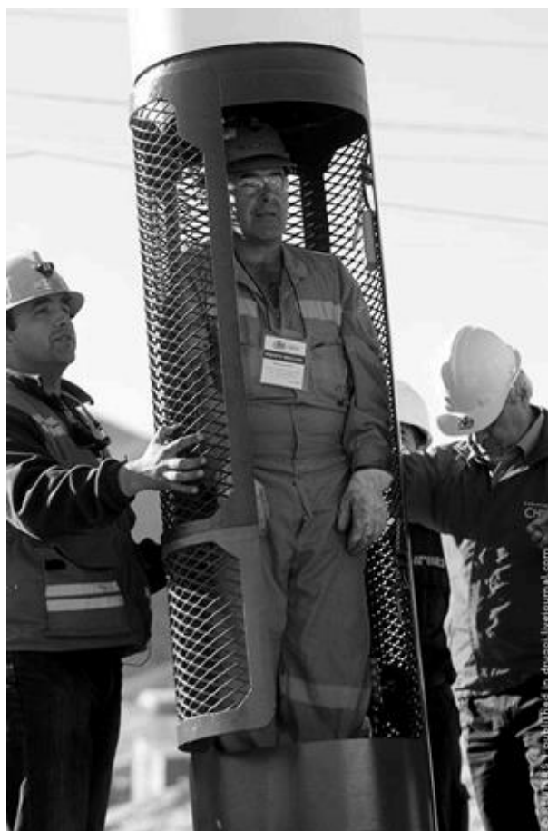
Рисунок 1 – Спасательная капсула примененная в Чилийской спасательной операции
