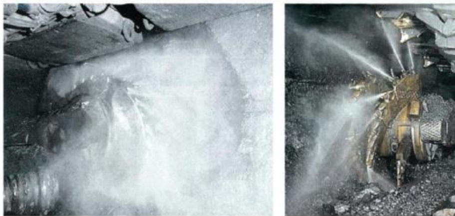
Рисунок 1 – Сопоставление эжекторного (слева) и традиционного орошения линии резания (справа)
