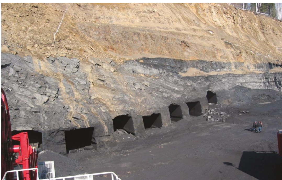
Рисунок 1 – Безлюдная выемка пласта с использованием КГРП, межкамерные целики
