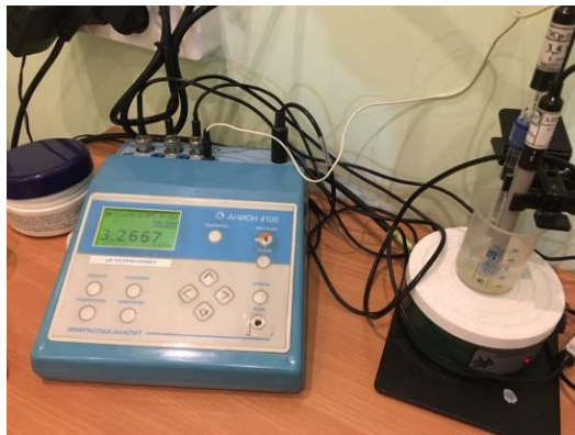
Рисунок 4 - Анализатор воды АНИОН 4100 (иономер)
