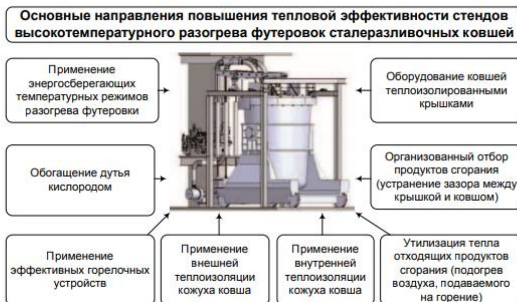
Рисунок 1 – Основные направления развития конструкций стандов и технологий высокотемпературного разогрева футеровок сталеразливочных ковшей
