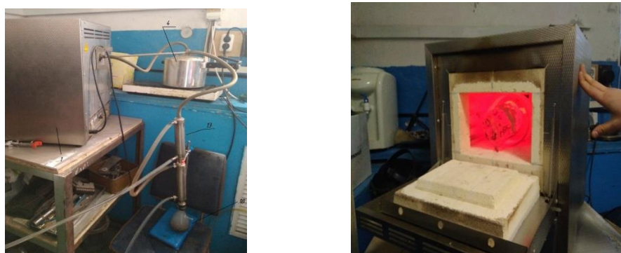
Рисунок 2 - Установка для активации угля
