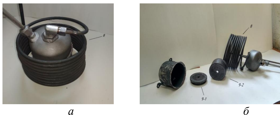
Рисунок 3 - Узел активации: а – в собранном виде, б – в разобранном виде
