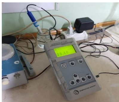
Рисунок 3 - Анализатор воды АНИОН – 7051 (рН-метр)
