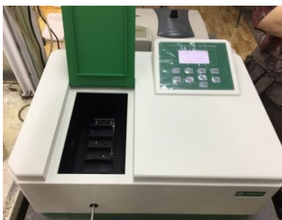
Рисунок 2 - Спектрофотометр ПЭ 5400 ВИ
