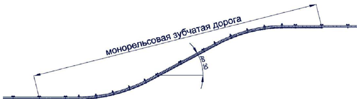
Рисунок 1 - Максимальный преодолеваемый подъём зубчатой дороги
