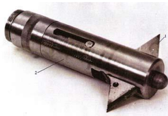
Рисунок 3 - Общий вид двухстороннего щелеобразователя: 1 — резец, 2 — корпус
