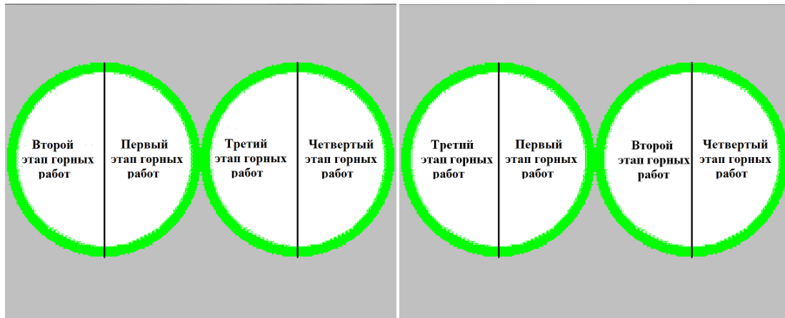
Рисунок 1. - Два варианта развития горных работ по раскрытию поперечного сечения двух параллельных тоннелей
