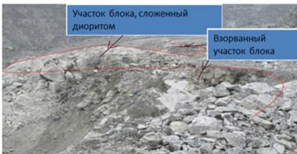
Рисунок 4 - Опытный блок после взрыва с неразрушенным участком, сложенным диоритом
