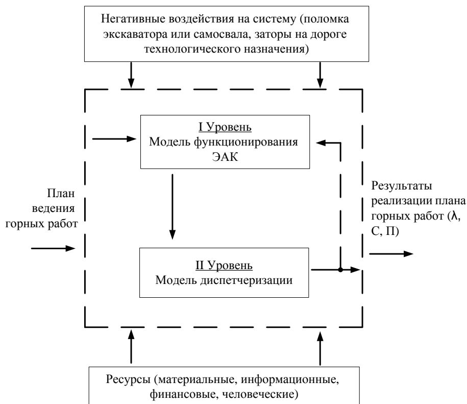
Рисунок 1 – Двухуровневая модель ЭАК разреза
