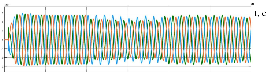
Рисунок 4 - Просадка напряжения на 0,6 кВ
