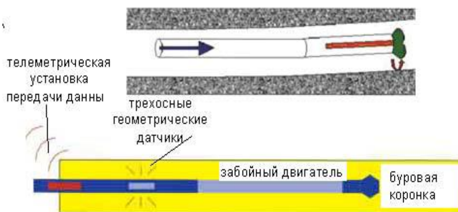
Рисунок 2 - Схема снаряда для направленного бурения скважин по углю
