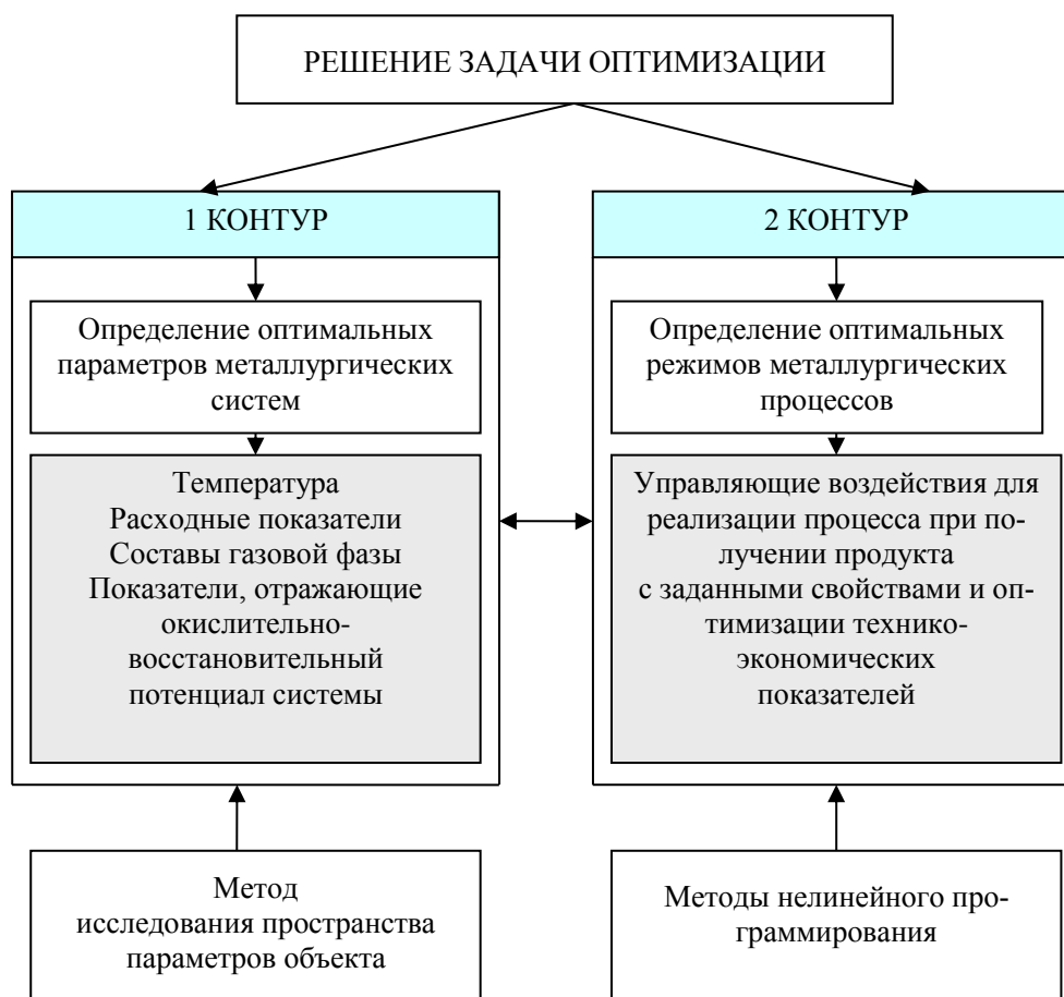
Рисунок 1– Схема решения задачи оптимизации
