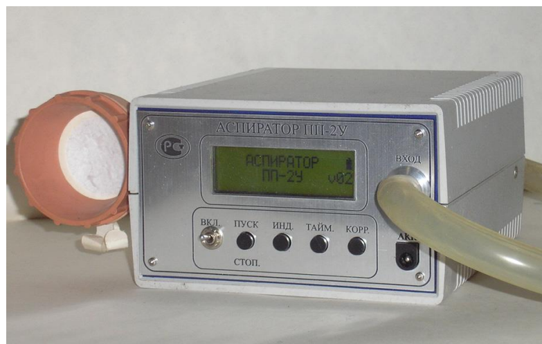
Рисунок 1 - Аспиратор-пылепробоотборник ПП-2У (ПП-2Ум) с индикацией текущего объема прокачанного воздуха, массы пыли на фильтре и концентрации пыли [3]
