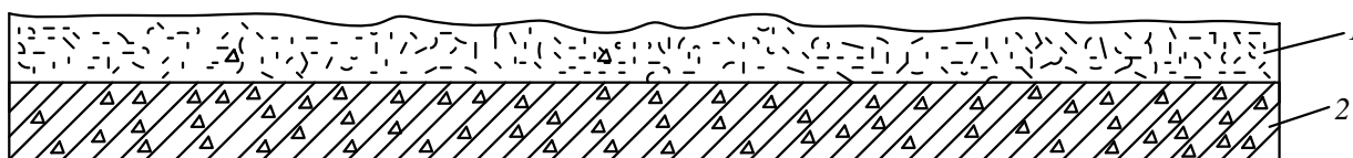
Рис. 2. Сцепление декоративного (1) и рабочего (2) слоев бетона
