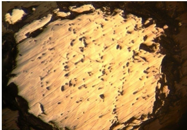
Рисунок 2 – Металлический марганец в силикатной массе (Увеличение \times 200 )
