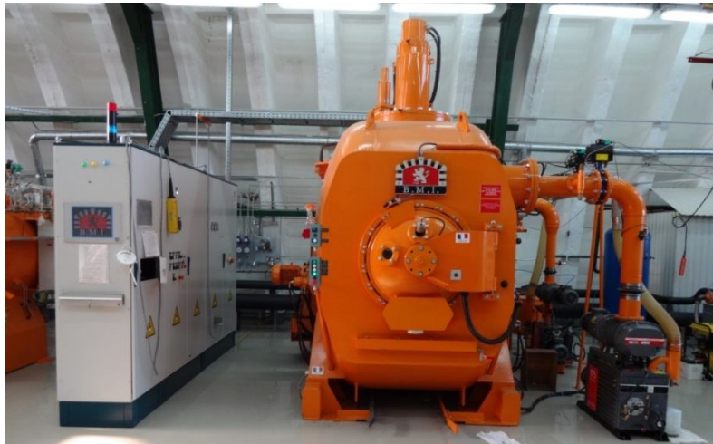
Рисунок 1 – Вакуумная печь ВМ1 В63 для термической обработки
