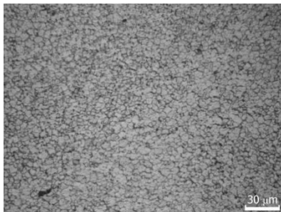
Рисунок 2 – Микроскопическое изображение микроструктуры зоны перемешивания в сплаве Д16
