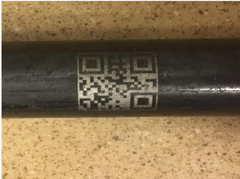
Рисунок 2- QR-код, нанесённый на буровую штангу Оборудованный QR-считывателем станок показан на рисунке 3.
