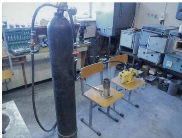
Рисунок 2-Установка для исследования процессов получения пористых литых заготовок и тонкостенных отливок
