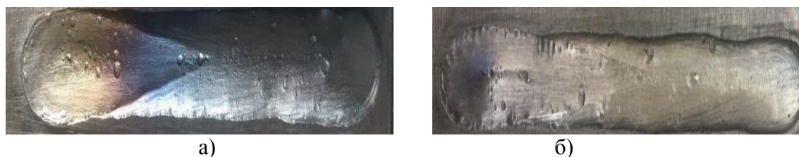
Рисунок 4 – Внешний вид валика при режимах сварки 700А-30В-30м/ч и 700А-32В-35м/ч
