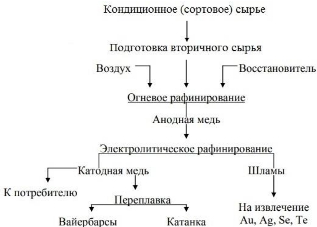
Рисунок 1 – Схема пирометаллургического производства меди из вторичного сырья
