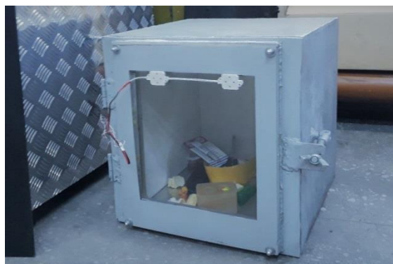
Рисунок 1 - Установка для исследования процессов литья и сварки в вакууме
