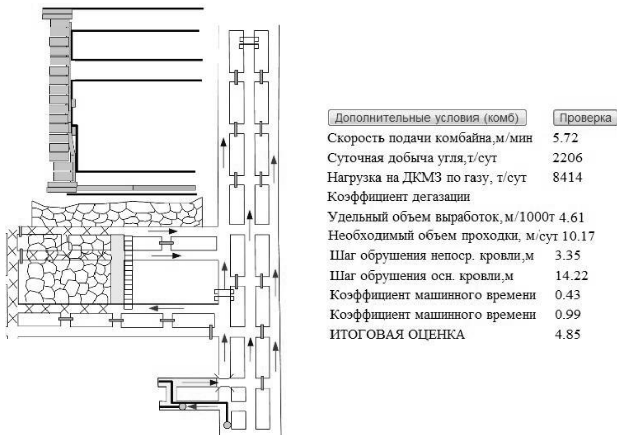
Рисунок 1 – Результаты расчета параметров технологической схемы очистного участка с использованием системы поддержки принятия решений
