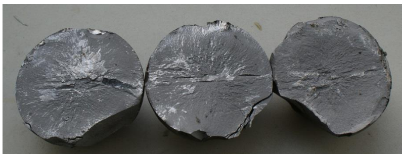
Рисунок 1 – Общий вид изломов шаров с флокенами после испытаний на ударную стойкость
