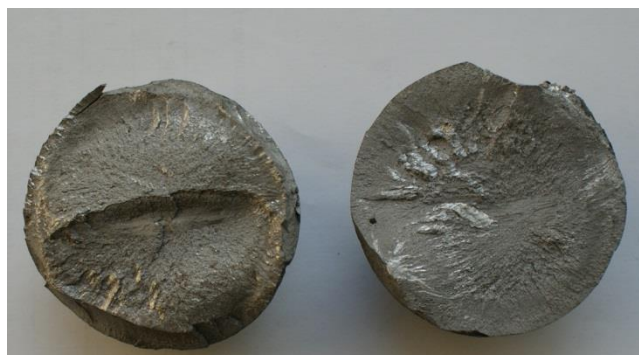
Рисунок 2 – Общий вид изломов шаров без видимых внутренних дефектов после испытаний на ударную стойкость
