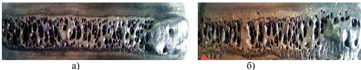
Рисунок 1 – Внешний вид валика при режимах сварки 700А-35В-35 м/ч и 680А-35В-35 м/ч
