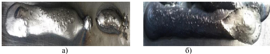
Рисунок 3 – Внешний вид валика при режимах сварки 680А-26В-26м/ч и 680А-26В-30м/ч
