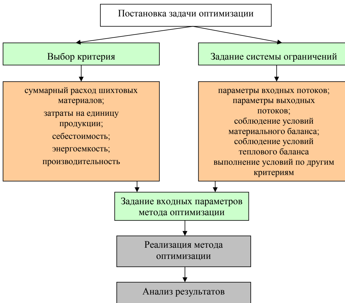
Рисунок 4 – Схема решения оптимизационной задачи
