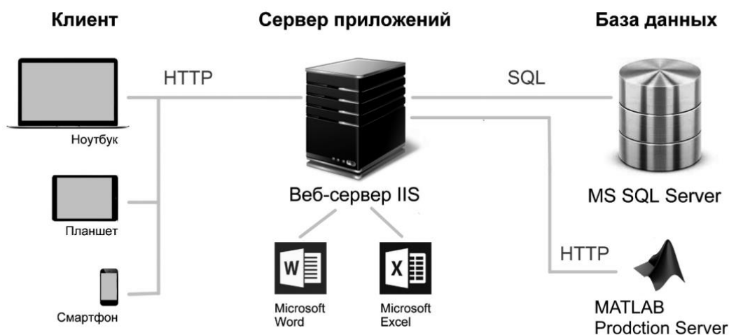
Рисунок 2 – Инфраструктура информационно-моделирующей системы, построенной на базе ASP.NET Core MVC
