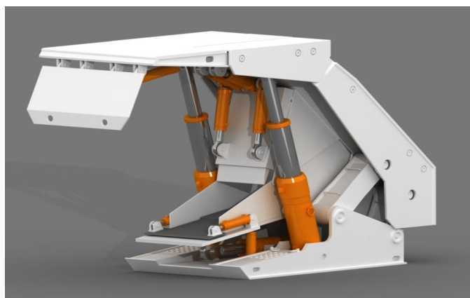
Рисунок 1 - Общий вид механизированной крепи с регулируемым выпуском угля на забойный скребковый конвейер
