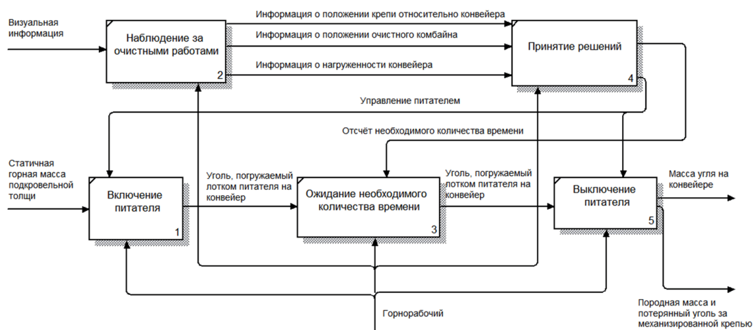
Рисунок 1 - IDEF0-модель механизированного выпуска угля подкровельной толщи
