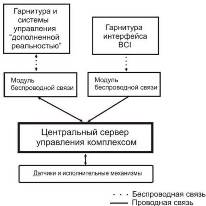
Рисунок 1 – Общая схема устройства мобильного рабочего места оператора очистного комплекса
