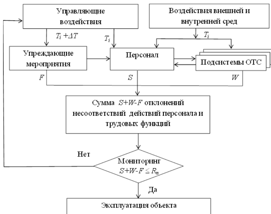
Рисунок 2 - Схема управления процессами взаимодействия подсистем в структуре ОТС погрузочно-транспортного предприятия
