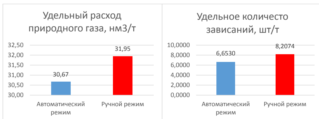
Рисунок 6 – Сравнение критериев эффективности работы системы автоматического управления тепловой работой шахтной печи за 1 квартал 2017
