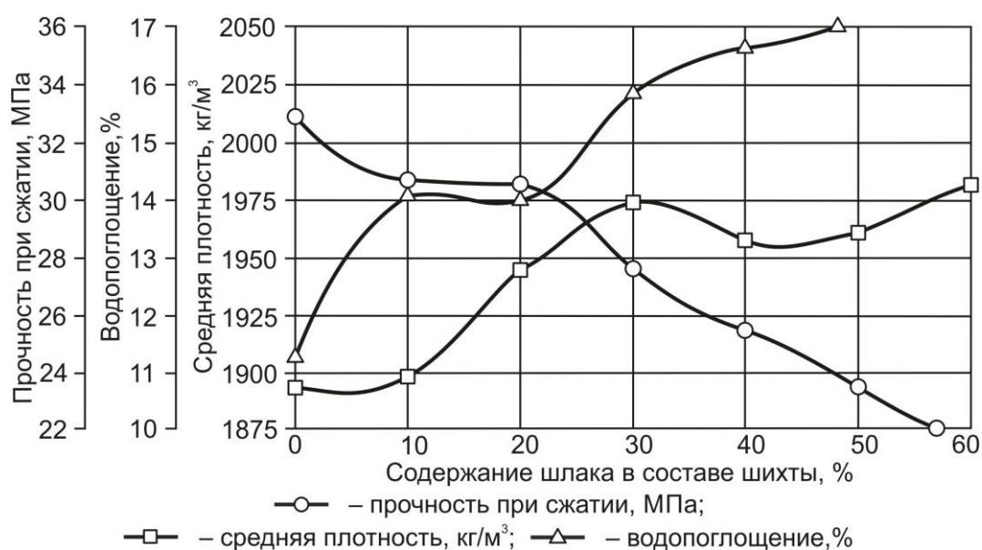
Рисунок 1 - Зависимость физико-механических свойств керамических образцов от количества шлака в составе шихты
