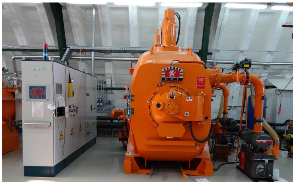
Рисунок 1 – Вакуумная печь ВМІ В63 для термической обработки
