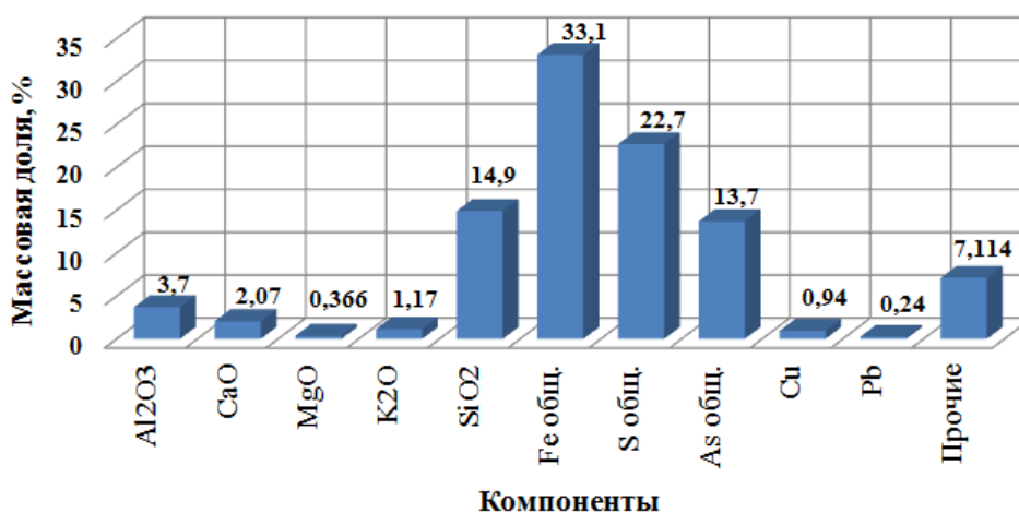
Рисунок 3 - Химический состав концентрата флотационного обогащения для крупности 95% -0,071мм
