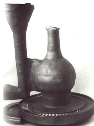
Рисунок 3 - а) Конструкция разработанной ЛПС и б) отливка диска (рисунок 1,б) с ЛПС по рисунку 3а
