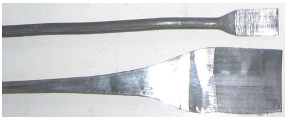
Рисунок 2 – Величина уширения при деформировании в валках (верхний образец) и способом “Конформ” (нижний образец)
