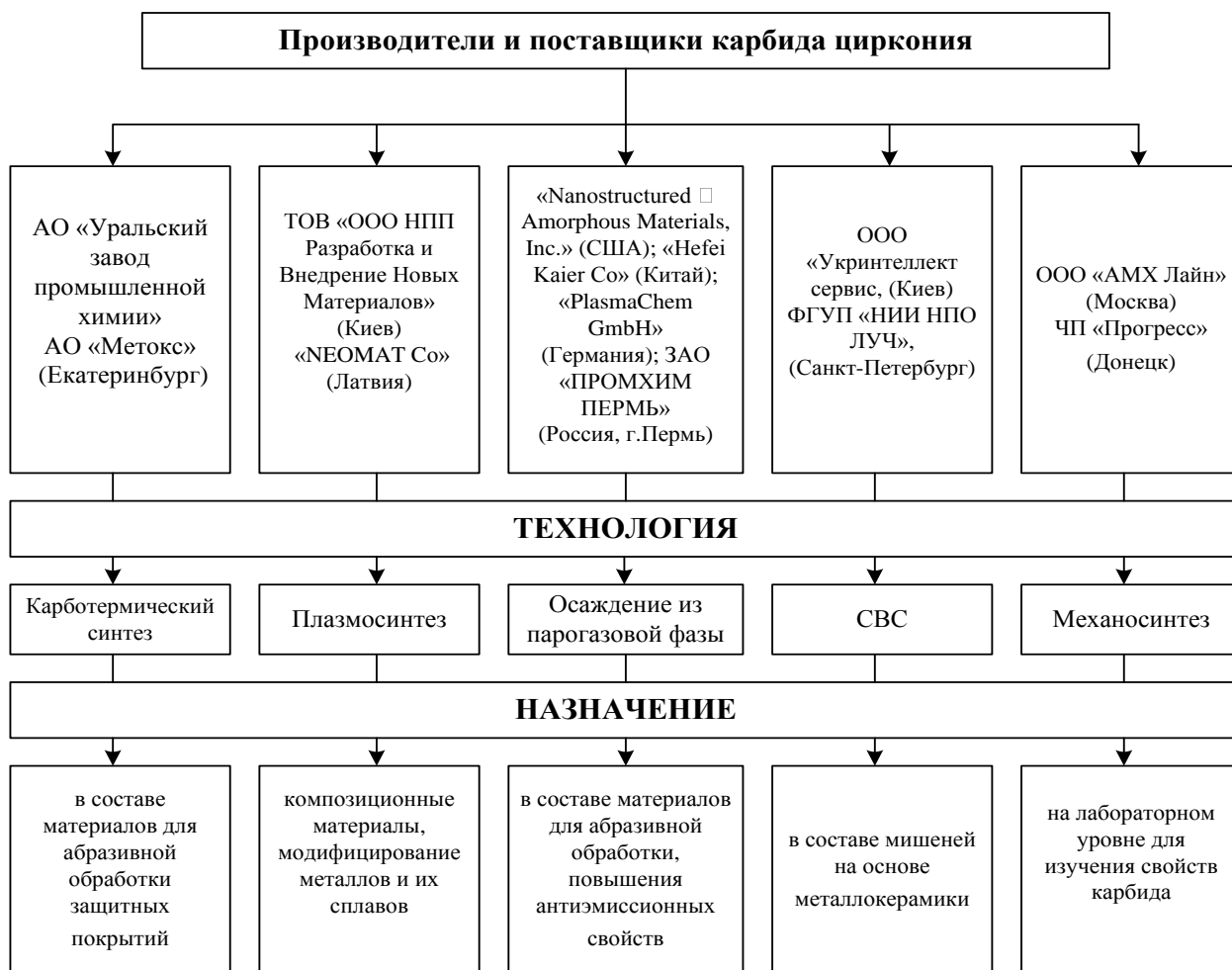
Рисунок 1 – Информация о производителях карбида циркония, реализуемых ими технологических вариантах его получения и основных областях применения
