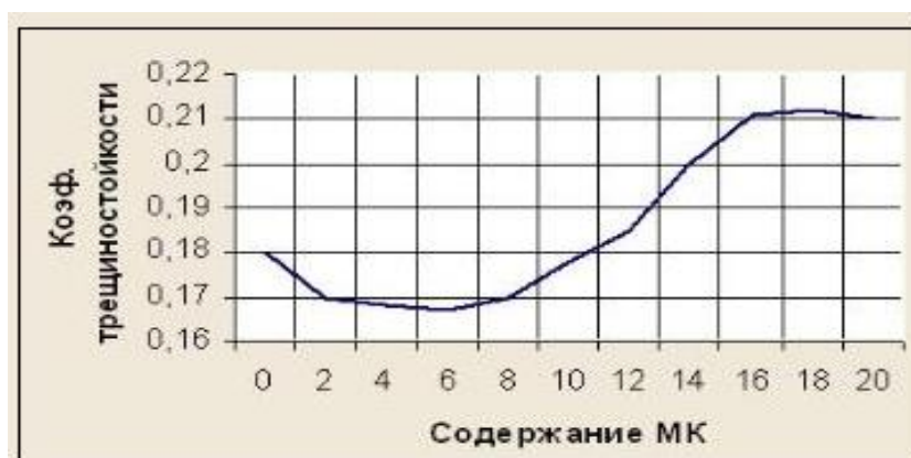
Рисунок 3 - Влияние количества добавки МКУ на трещиностойкость бетона
