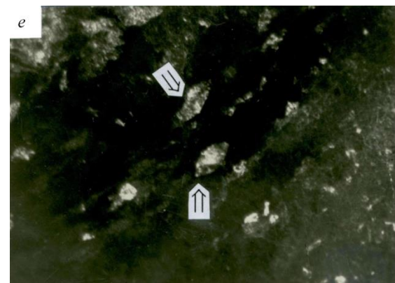
Рисунок 7 – Электронно-микроскопическое изображение тонкой структуры стали 20X2H4A после нитроцементации (обр. 12, поверхность зуба) (а-в) и после нитроцементации, последующего высокого отпуска (620 °С, 1 час) и закалки в масло от 820 °С (обр. 14, расстояние 2,0 мм от поверхности зуба) (г-е). Остаточный аустенит (γ) внутри самоотпущенного мартенсита в виде колоний
