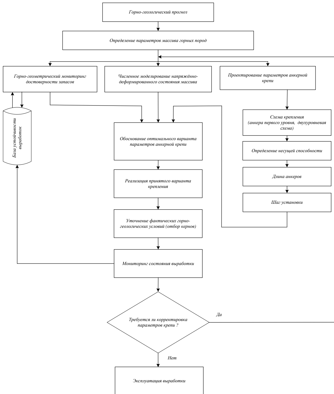
Рис. 1. Алгоритм обеспечения устойчивости подготовительных выработок
