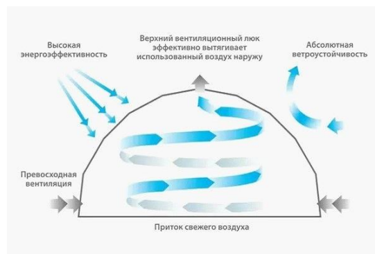
Рис. 3. Схема воздухообмена в купольном сооружении
