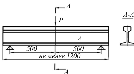
Рис. 2. Схема испытания на статический поперечный изгиб
