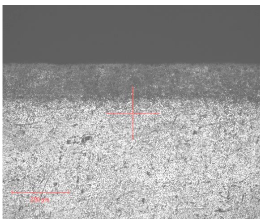
Рисунок 2 – Микроструктура стали марки 40X13 после азотирования
