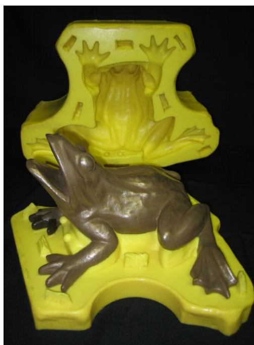
Рисунок 3 – Пример отливки с введенным наполнителем
