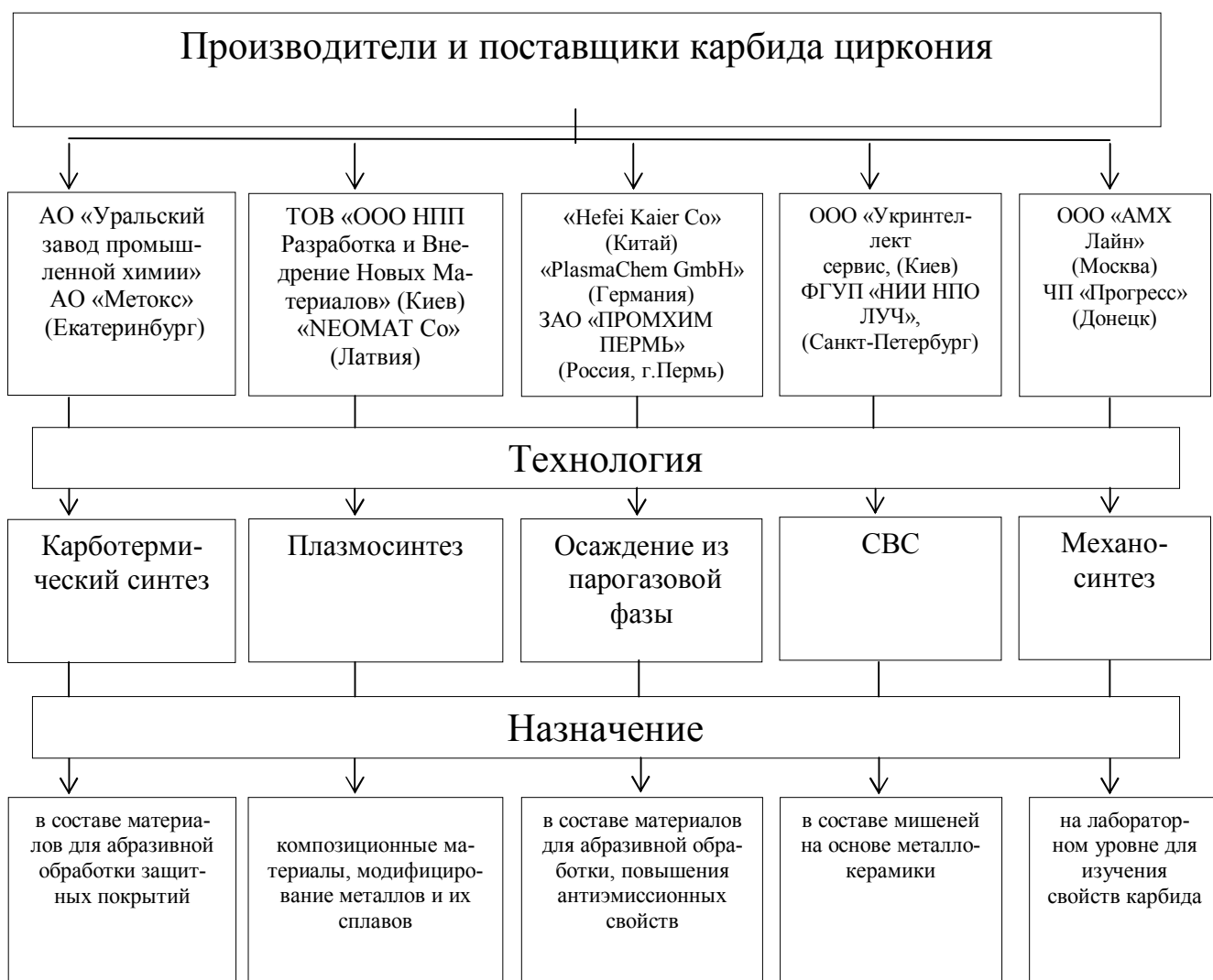
Рисунок 6 – Информация о производителях карбида циркония, реализуемых ими технологических вариантах его получения и основных областях применения
