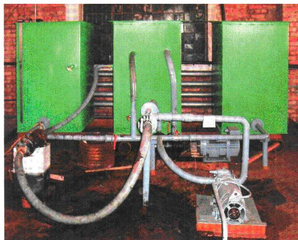
Калибровочный стенд с подключённым измерителем
