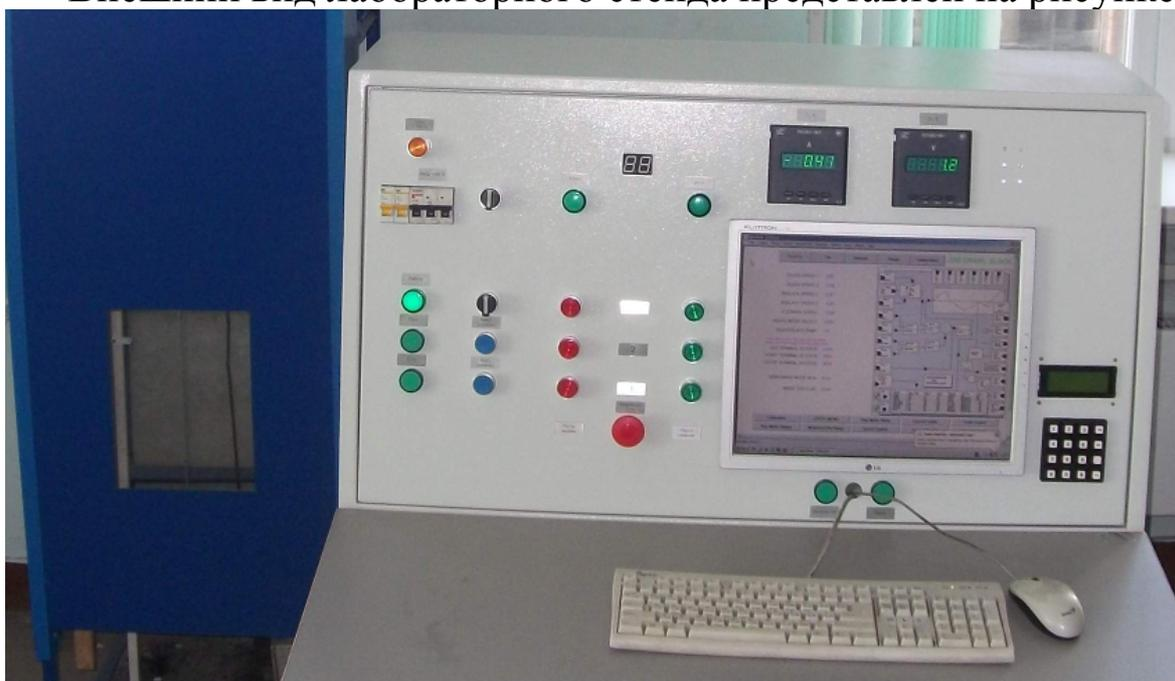
Рисунок 2 — Стенд по исследованию электропривода лифта
