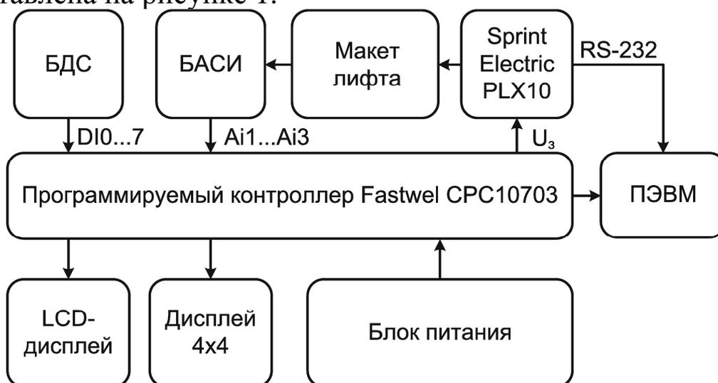
Рисунок 1 — Блок-схема стенда на основе программируемого контроллера Fastwel CPC10703
