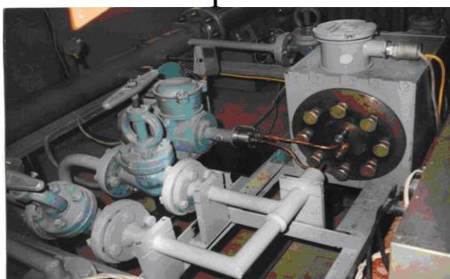
Рисунок 1 – Проточный ЯМР-анализатор скважинной жидкости
