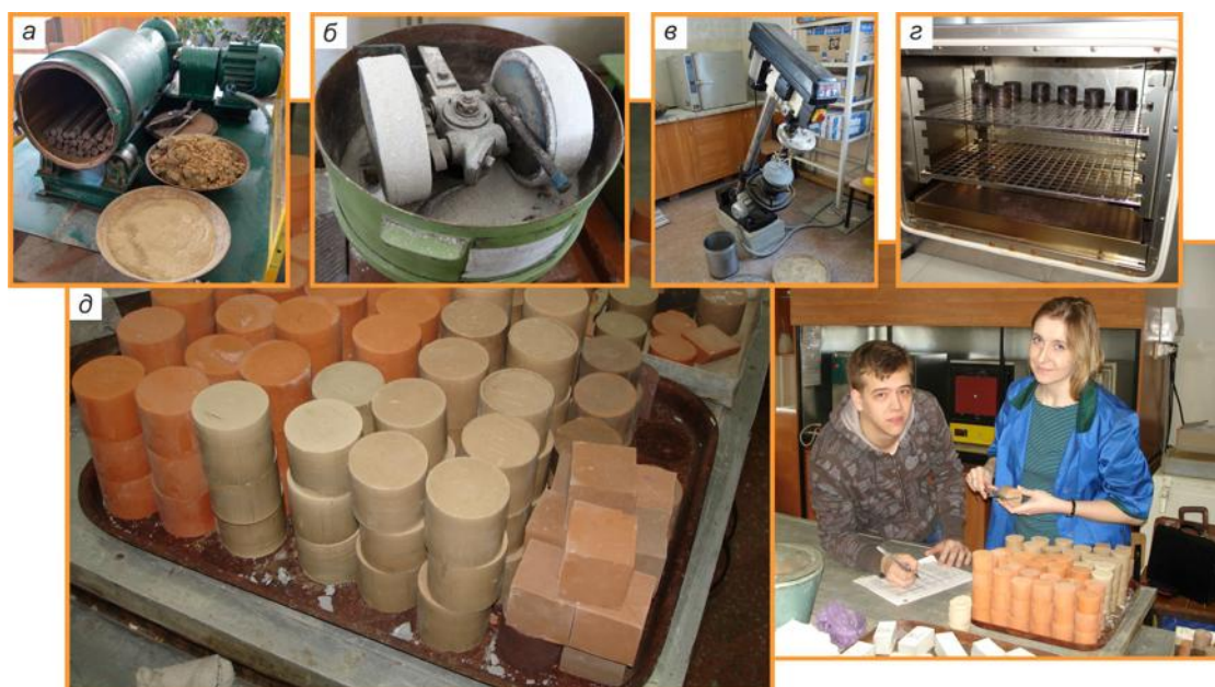
Рисунок 1 –Лабораторное оборудование для приготовления керамических образцов:
