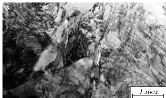
Рис. 4. Участок верхнего бейнита в структуре пробы 1 рельса категории Т1 из стали марки Э76Ф
