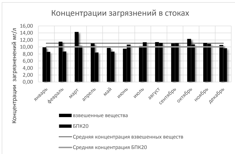
Рисунок 1 – Концентрации загрязнений поступающих сточных вод за 2015 год
