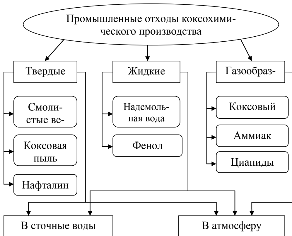
Рисунок 1 – Классификационная схема промышленных отходов КХП
