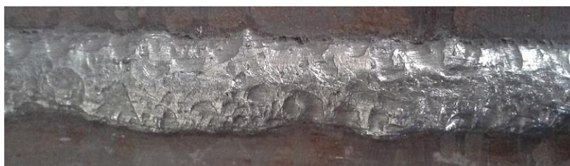
Рисунок 1 – Наплавленный валик без добавления углеродфторсодержащей добавки
