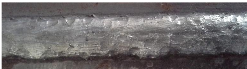
Рисунок 3 – Наплавленный валик с 3% добавлением углеродфторсодержащей добавки.
