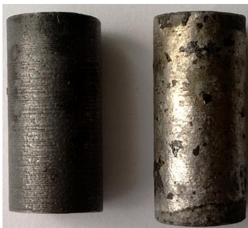
Рисунок 3 – Поверхности образцов нагретых без покрытия (слева) и с покрытием (справа)
