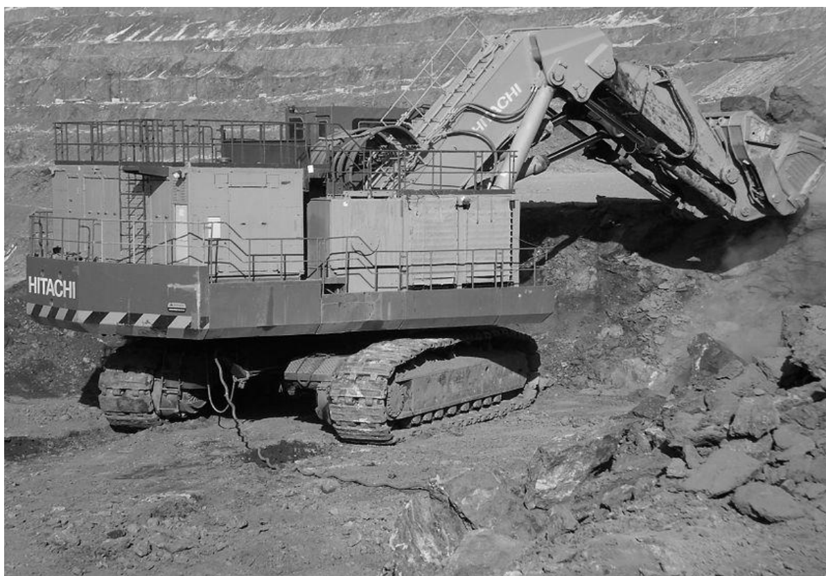
Рисунок 1 – Электрогидравлический экскаватор Hitachi EX-5500 E-6LD
