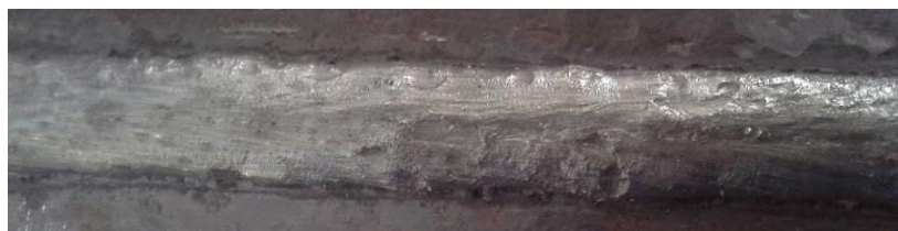
Рисунок 5 – Наплавленный валик с 7% добавлением углеродфторсодержащей добавки.
