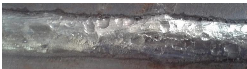
Рисунок 2 – Наплавленный валик с 1% добавлением углеродфторсодержащей добавки.
