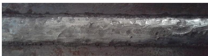
Рисунок 4 – Наплавленный валик с 5% добавлением углеродфторсодержащей добавки.
