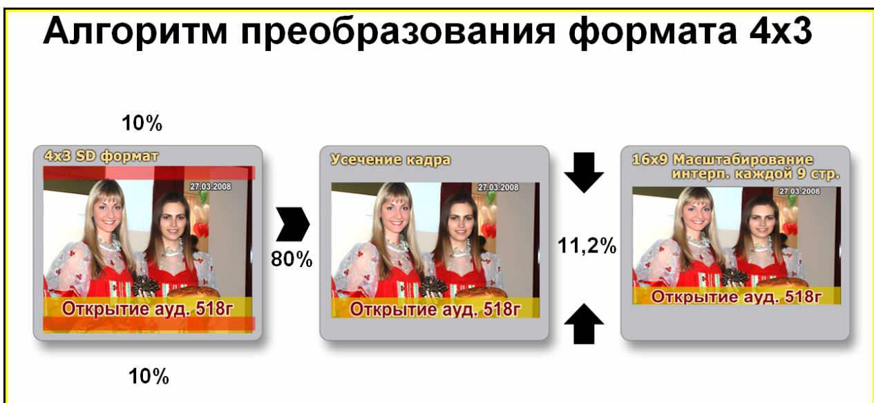
Рисунок 3 - Алгоритм преобразования цифрового видео сигнала
