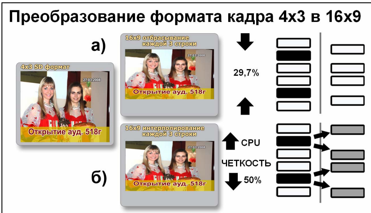
Рисунок 1 - Методы масштабирования изображения: а – отсечения строк; б – интерполирования строк
