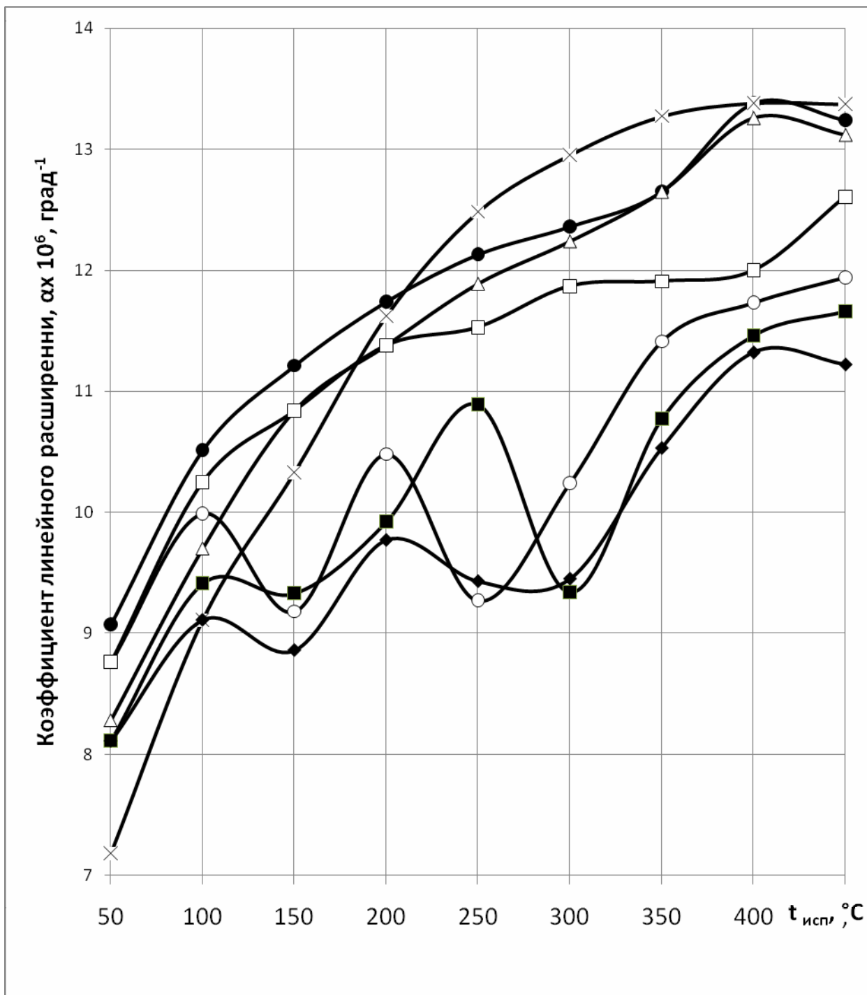
Рисунок 2 - Влияние цементации в бондюжском карбюризаторе с водяным паром ( t=(550-600)^{\circ}\text{C} , \tau=1\text{ч} , воздух) и последующей термической обработки на коэффициент линейного расширения стали Р6М5 -●- без нагрева, -■- +1000^{\circ}\text{C} , 15 мин, вода, -×- +560^{\circ}\text{C} , 1ч, воздух, -△- +560^{\circ}\text{C} , 1ч, воздух, -◆- +3 \times (1000^{\circ}\text{C} , 15 мин, вода), -○- +2 \times (1000^{\circ}\text{C} , 15 мин, вода), -□- +250^{\circ}\text{C} , 2ч, воздух
