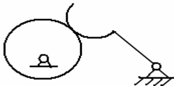
Рисунок 3 - Кулачковый механизм с плоской однозвенной группой Ассур.
