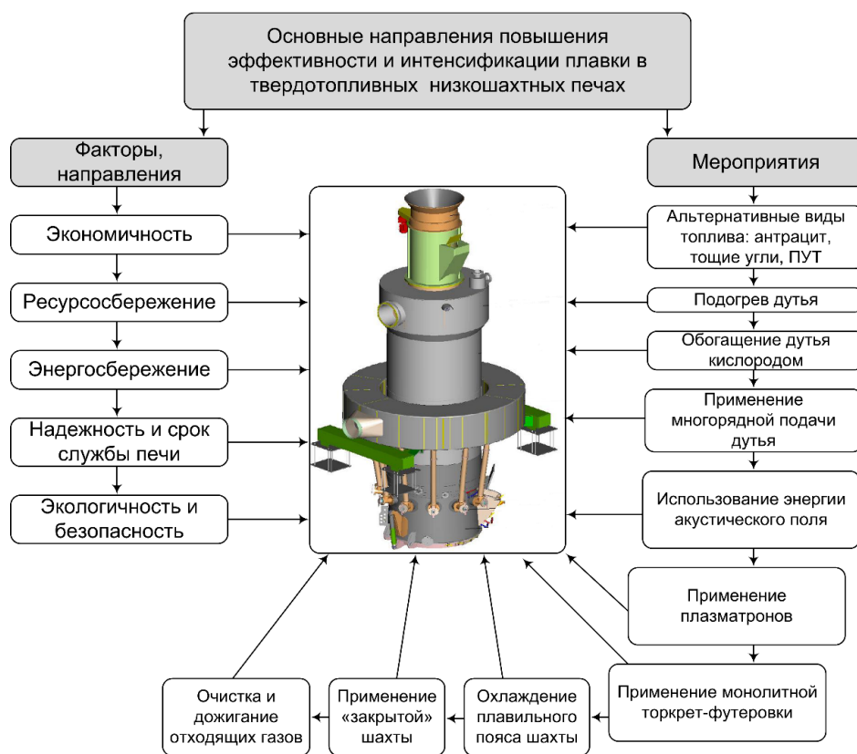
Рисунок 1 – Основные направления развития конструкций и технологий плавки в твердотопливных низкошахтных печах
