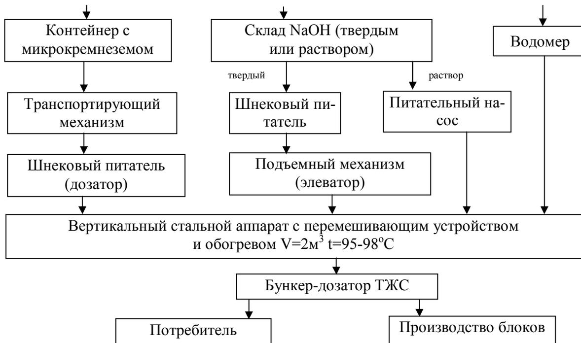
Рисунок 1 – Технологическая схема производства технического жидкого стекла
