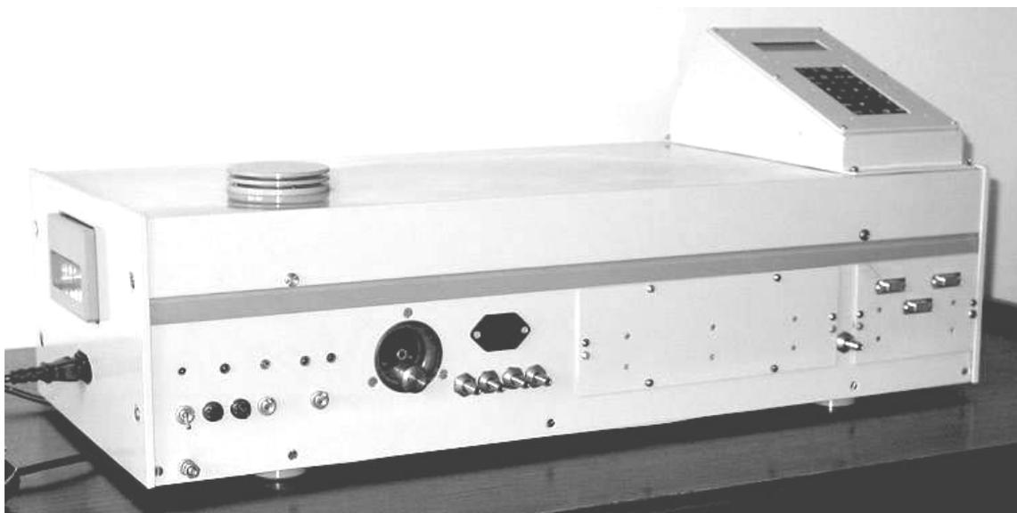
Рисунок 3 – Внешний вид газоанализатора ДОГ-4
