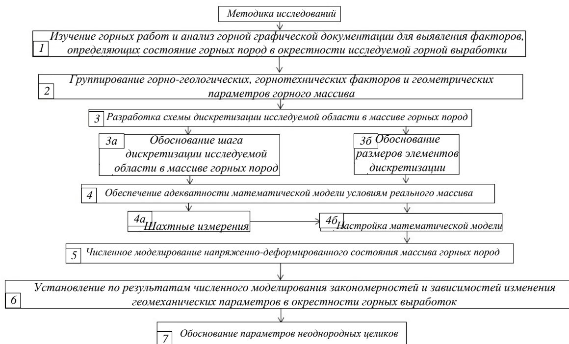
Рис. 1. Структура методики численного исследования напряженно-деформированного состояния неоднородных угольных целиков
