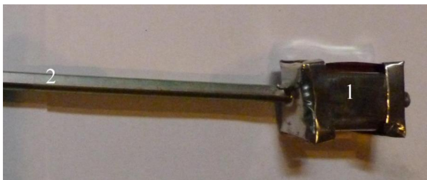
1 – камера для ввода экзотермической смеси, разрушаемая под действием теплоты жидкого чугуна; 2 – кронштейн
