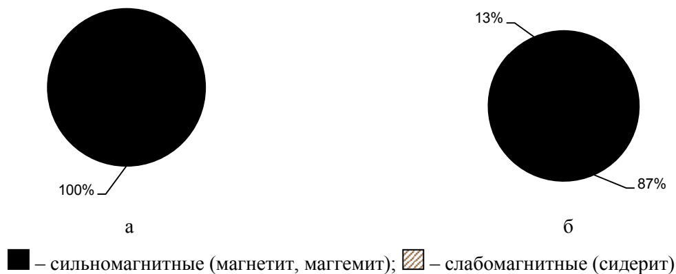
Рисунок 3 – Распределение сильномагнитных и слабомагнитных железосодержащих фаз в отходах углеобогащения
