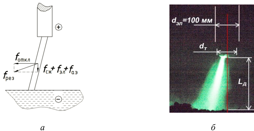
Рисунок 4 – Действие сил на дугу (а) и геометрические параметры (б)
