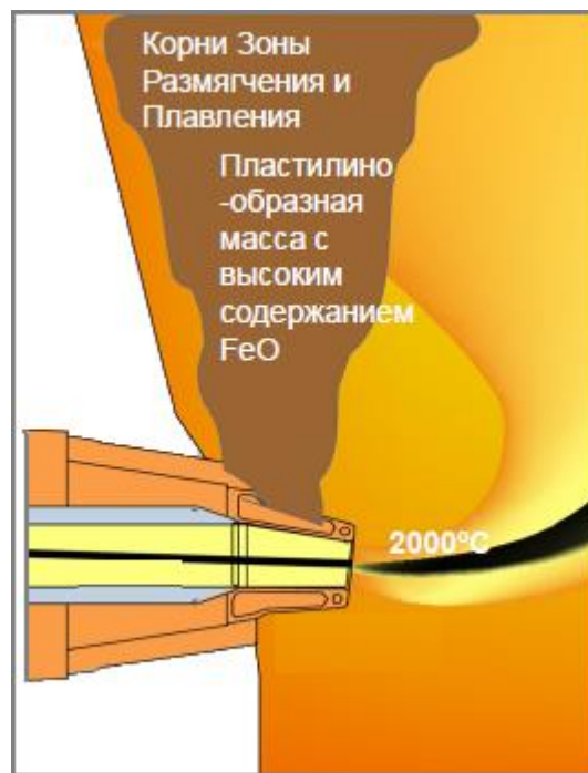
Рисунок 5 – Изображение зоны размягчения и плавления
