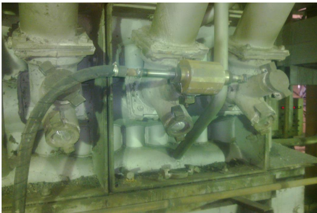
Рисунок 2 – Установка акустического излучателя на фурмах шахтных печей
