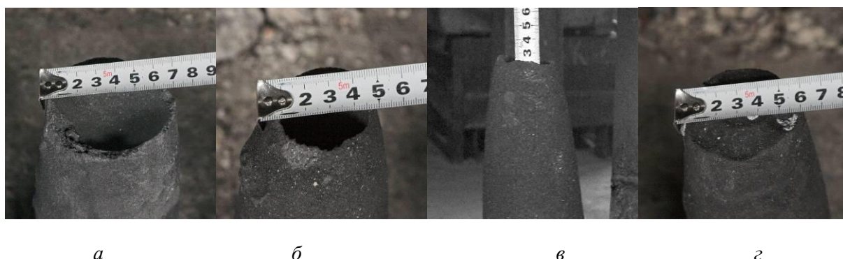
Рисунок 6 – Электроды дуговой печи диаметром 100 мм после проведения плавки
