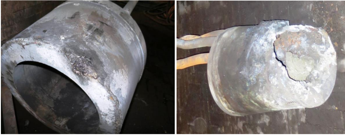
Рисунок 1 – Прогар элементов фурменного прибора
