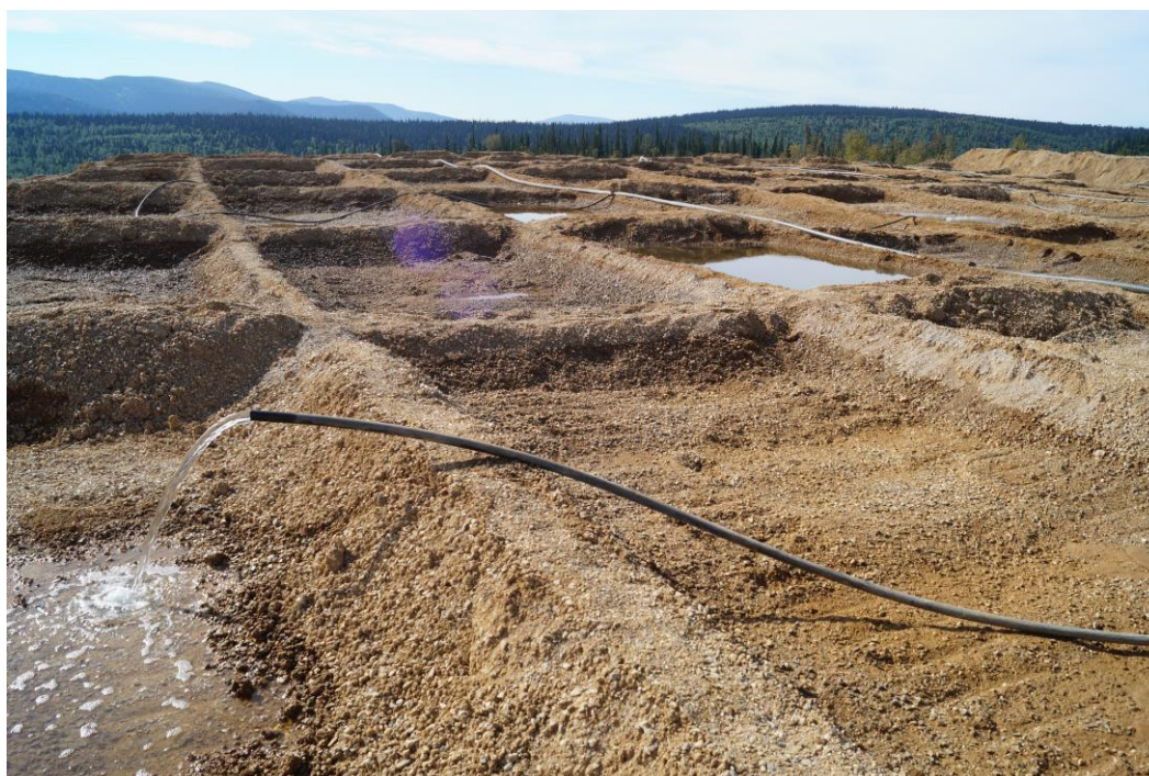
Рисунок 1 – Цианирование рудного штабеля (фото автора)
