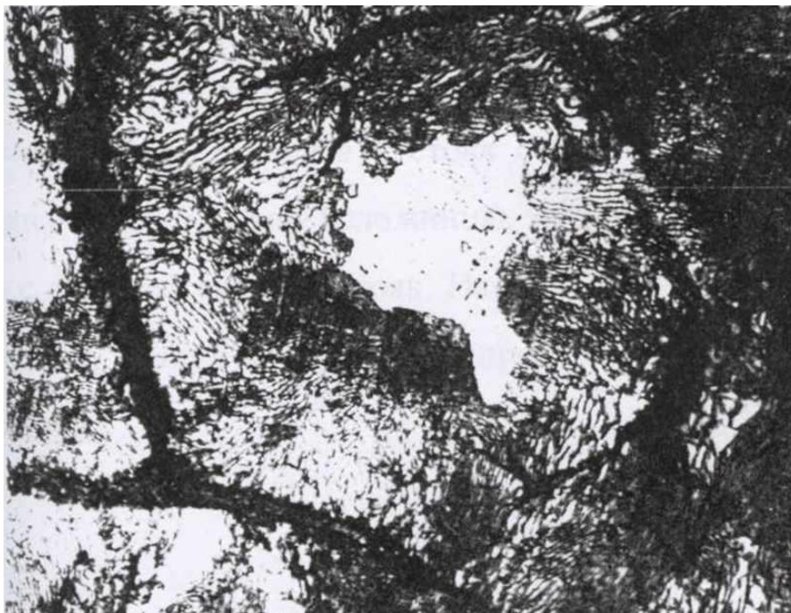
Рисунок 3 – Равномерное распределение мелких карбонитридов в фосфидной эвтектике после продувки (содержание фосфора в чугуна составляет 0,3 %) (×800)
