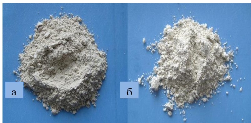
Рисунок 2 – Порошки глин Трошковского (а) и Никольского (б) месторождений после обработки
