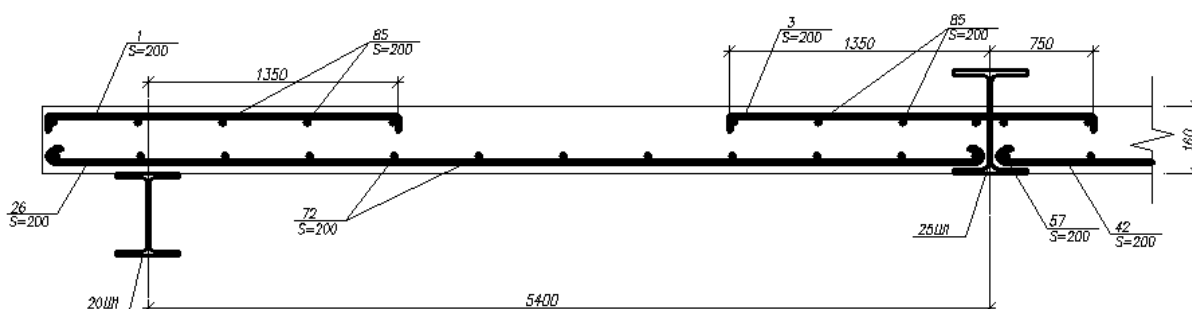
Рисунок 3 - Армирование монолитной плиты перекрытия
