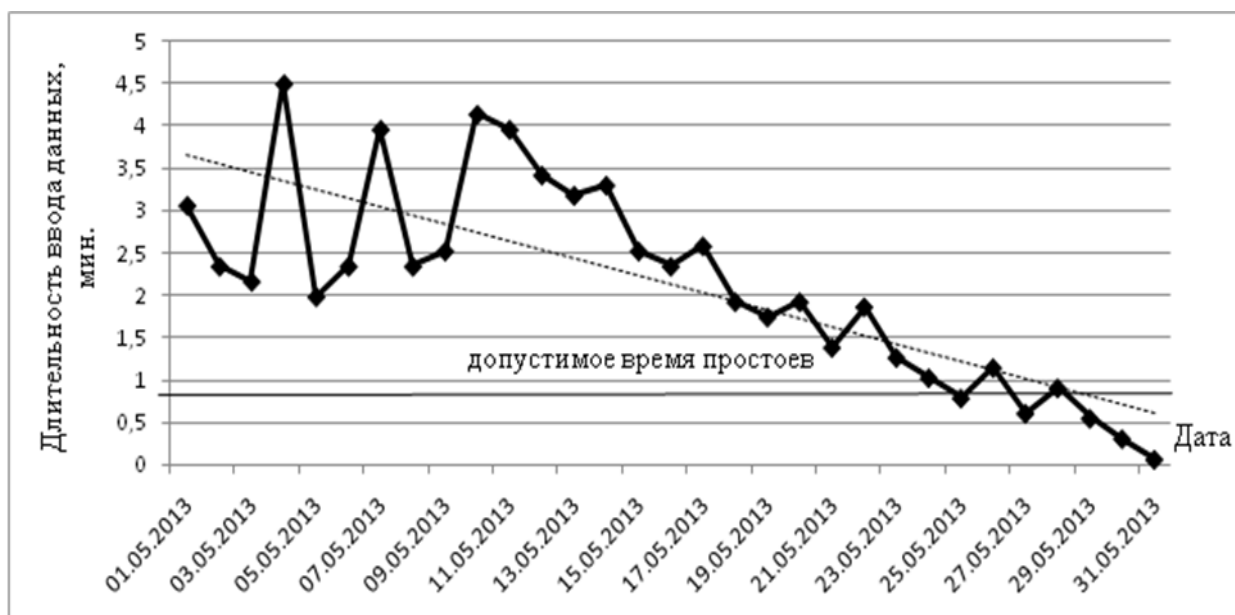
Рисунок 3 – Длительность простоя стана 450 после внедрения проекта На рисунке 4 представлена схема межцеховой информационной сети.
