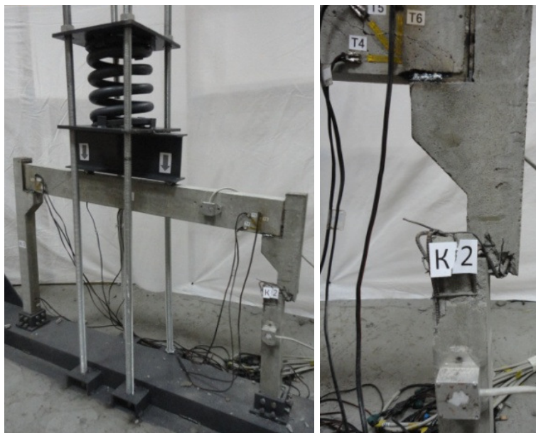
Рисунок 5 – Модель рамы после разрушения колонны
