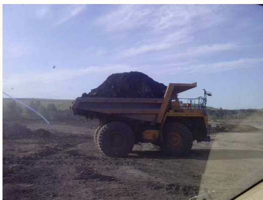
Рисунок 4 - Грузеный самосвал: Полная масса = 40,5 + 55 = 95,5 тонн
