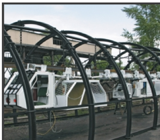
Рисунок 2 - Монорельсовая подвесная дорога ДП-155
