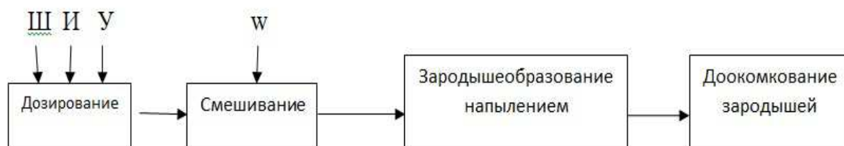
Рисунок 1 – Схема получения железорудных окатышей по технологии принудительного зародышеобразования
