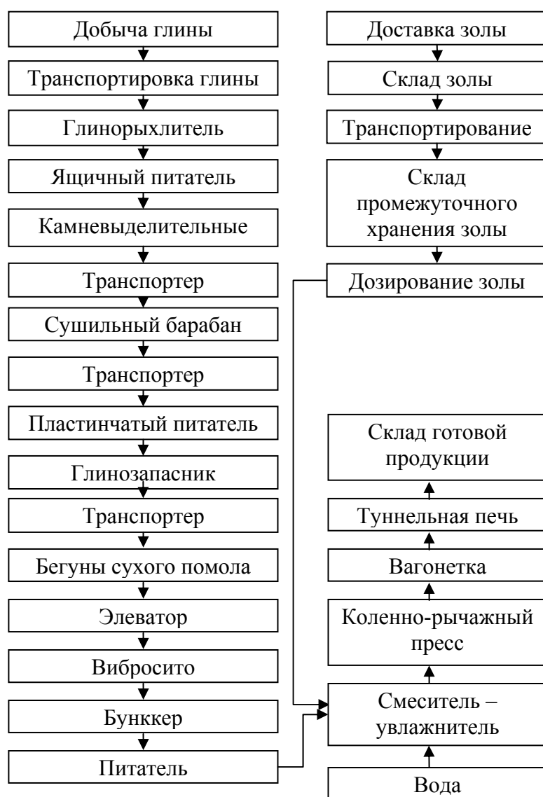
Рисунок 1 – Технологическая схема производства керамического кирпича
