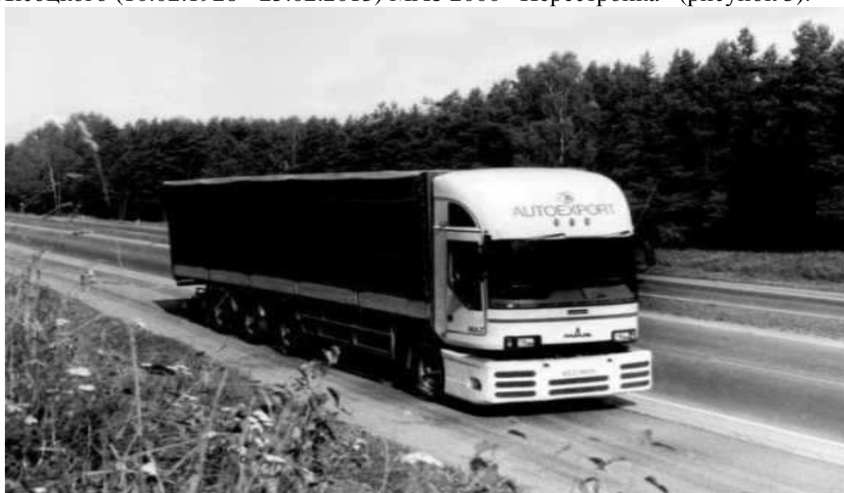
Рисунок 3 – Фото прототипа МАЗ 2000 "Перестройка" (экземпляр №1)
