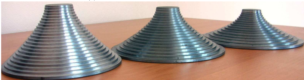
Рисунок 2 – Опытные образцы полукатеноидальных ударников
