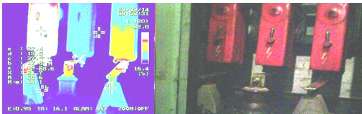
Рисунок 1. Термограмма высоковольтного выключателя
