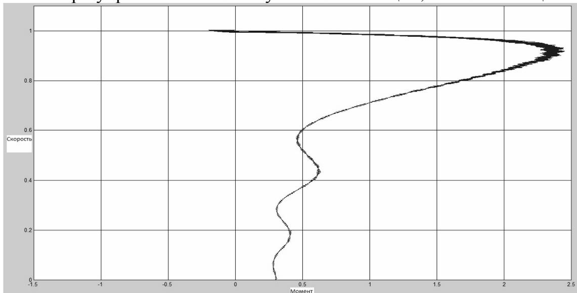
Рисунок 7. Механическая динамическая характеристика пуска двигателя при управлении по закону постоянства абсолютного скольжения
