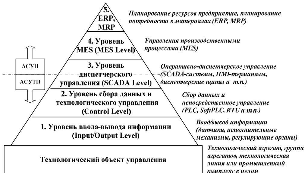
Рисунок 1. Функциональная структура САУ промышленным комплексом
