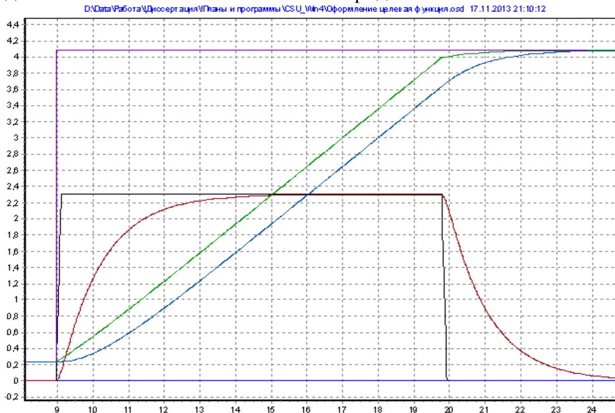
Рисунок 5. Переходный процесс в контуре ЭДС при использовании структуры, представленной на рисунке
