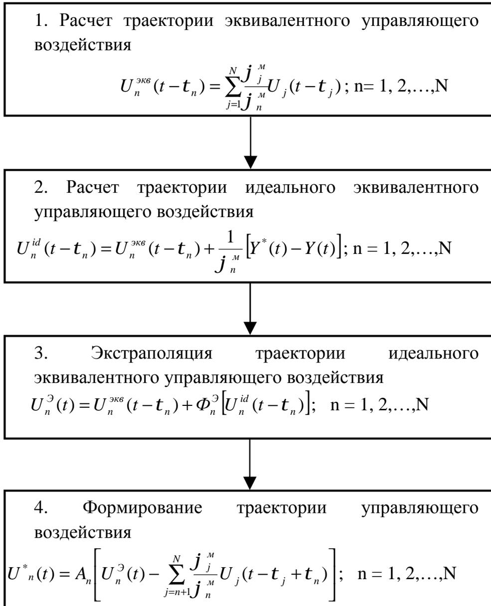
Рисунок 2. Укрупненная структура алгоритма регулирования
