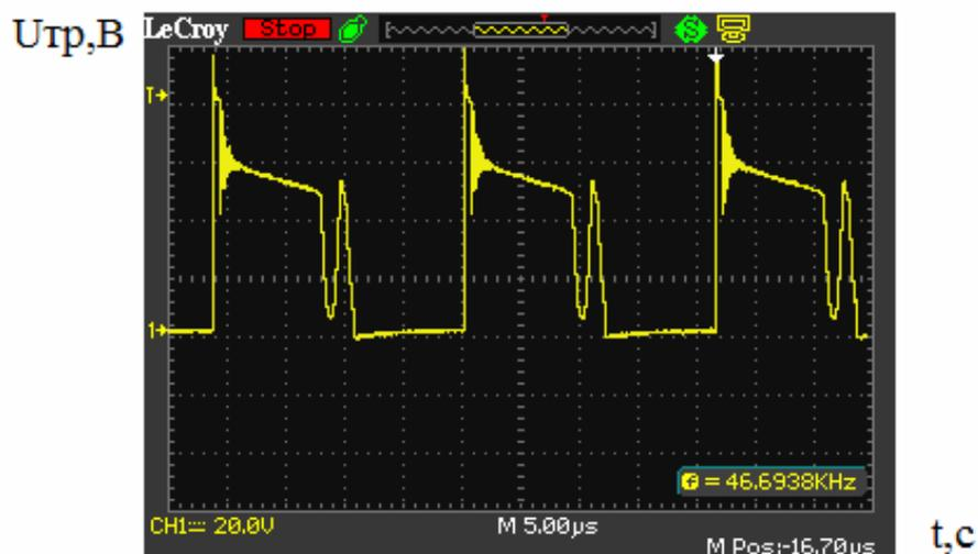
Рисунок 8. Осциллограмма напряжения “сток-исток” ключевого транзистора
