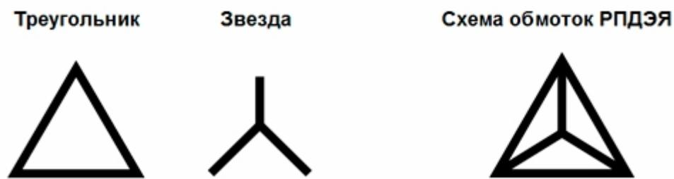
Рисунок 4. Схема обмоток асинхронных двигателей
