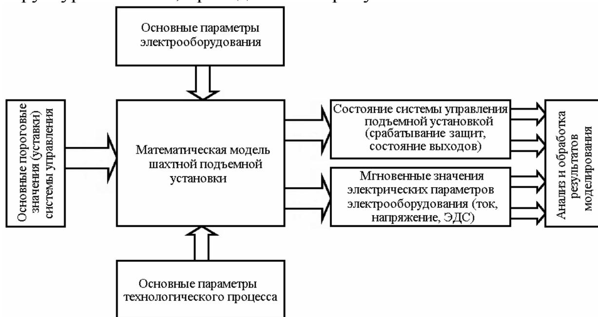
Рисунок 3. Структурная схема системы математического моделирования системы управления подъемной установки
