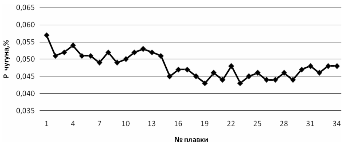
Рисунок 3 – Информативный участок изменения содержания фосфора чугуна
