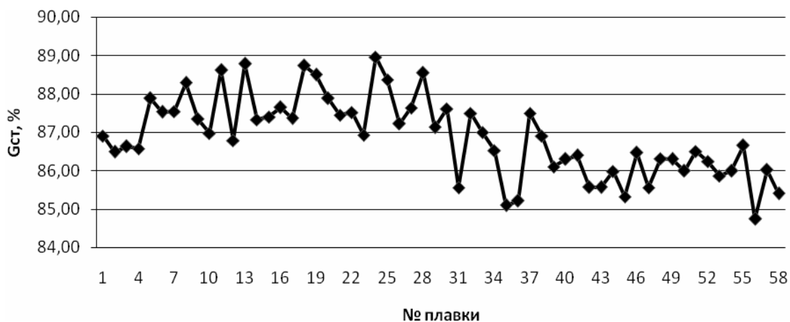
Рисунок 6 – Информативный участок изменения выхода жидкой стали
