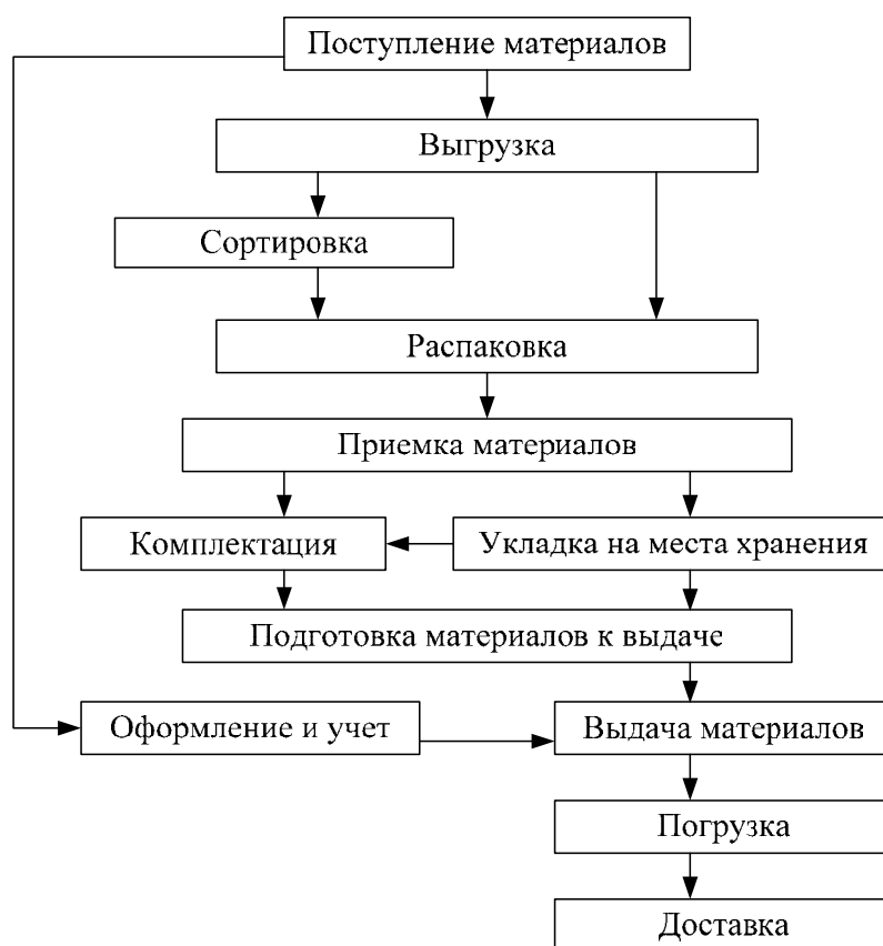
Рисунок 1 – Типовой технологический процесс работы терминала
