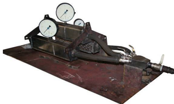
Рис. 1. Опытная установка дифференцированной термической обработки рельсов типа Р65 сжатым воздухом
