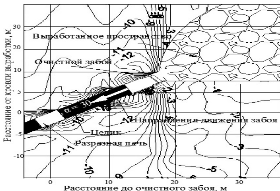
Рисунок 5 – Распределение полных вертикальных напряжений при ширине целика 10 м и угле падения пласта \alpha=30^0
