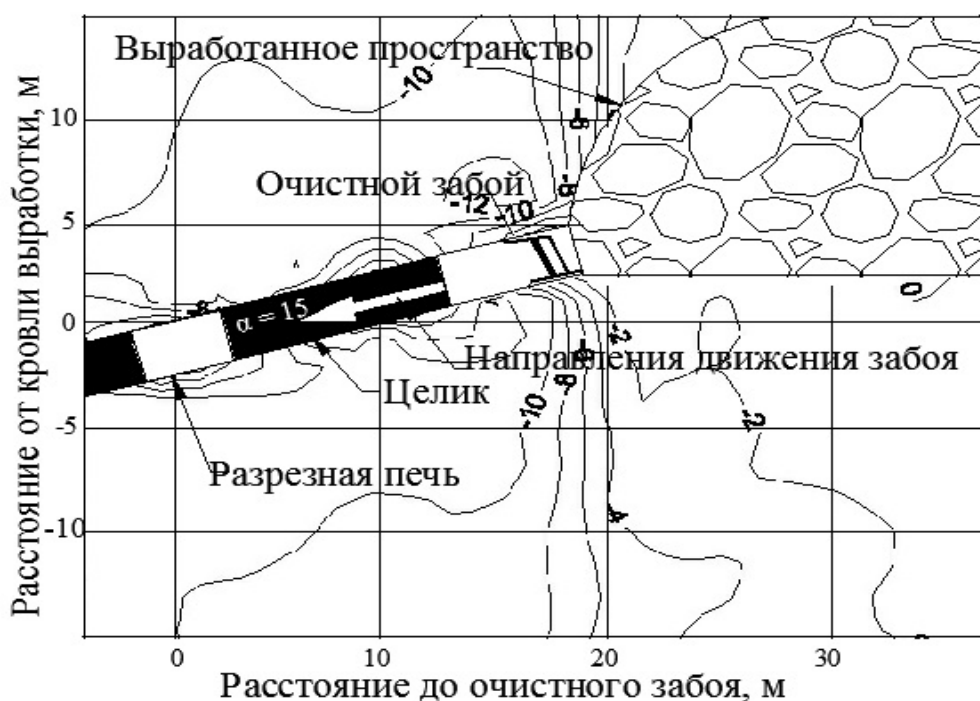
Рисунок 4 – Распределение полных вертикальных напряжений при ширине целика 10 м и угле падения пласта \alpha=15^{\circ}
