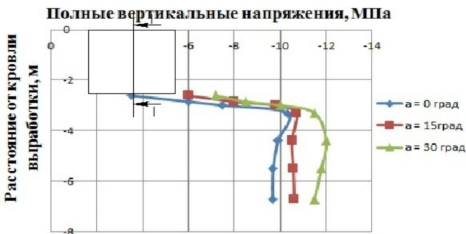
Рисунок 5 - Распределение полных вертикальных напряжений по оси выработки при ширине целика 10 м относительно угла падения пласта
