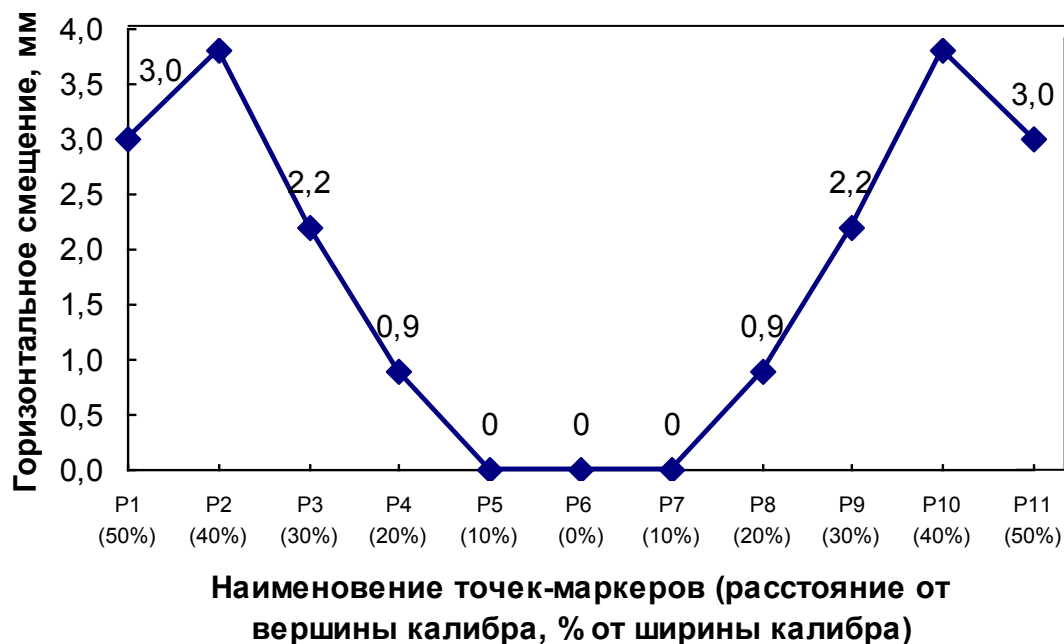
Рисунок 4 – Течение поверхностных слоев металла при прокатке квадратной заготовки в ящичном калибре
