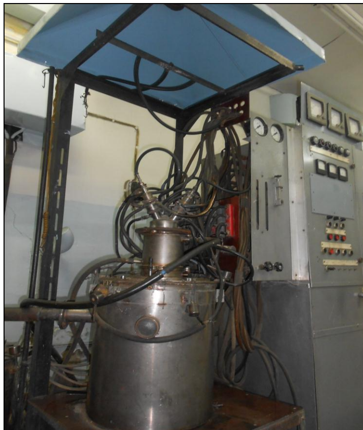
Рисунок 4 – Трехструйный прямоточный вертикальный плазменный реактор мощностью 150 кВт
