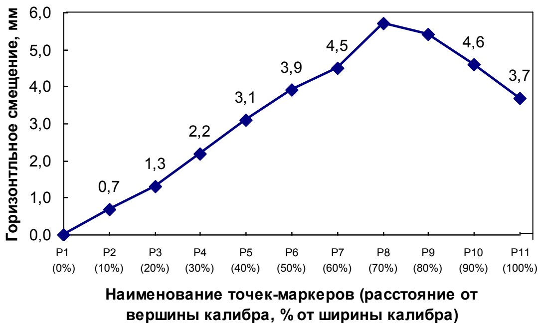
Рисунок 2 – Течение поверхностных слоев металла при прокатке квадратной заготовки в ромбическом калибре
