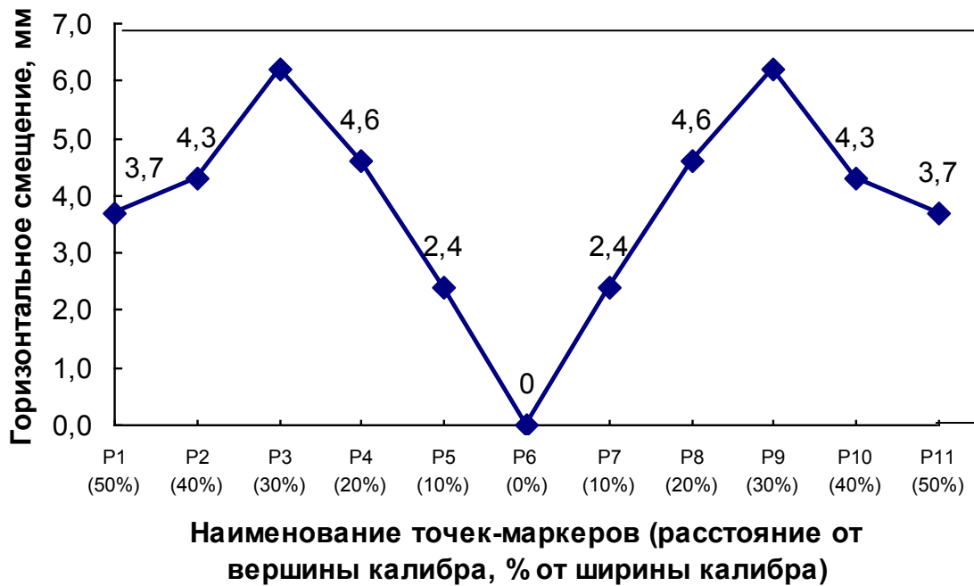
Рисунок 3 – Течение поверхностных слоев металла при прокатке квадратной заготовки в овальном калибре
