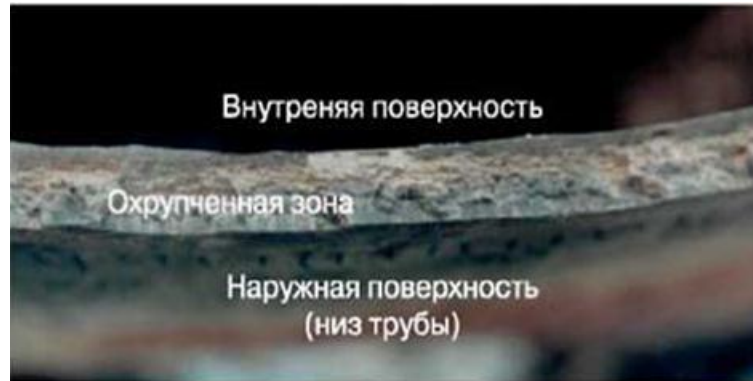
Рисунок 2 – Стресс-коррозионный излом магистрального газопровода: охрупченная зона вблизи наружной КЗП, на глубине 0,3...0,5 мм
