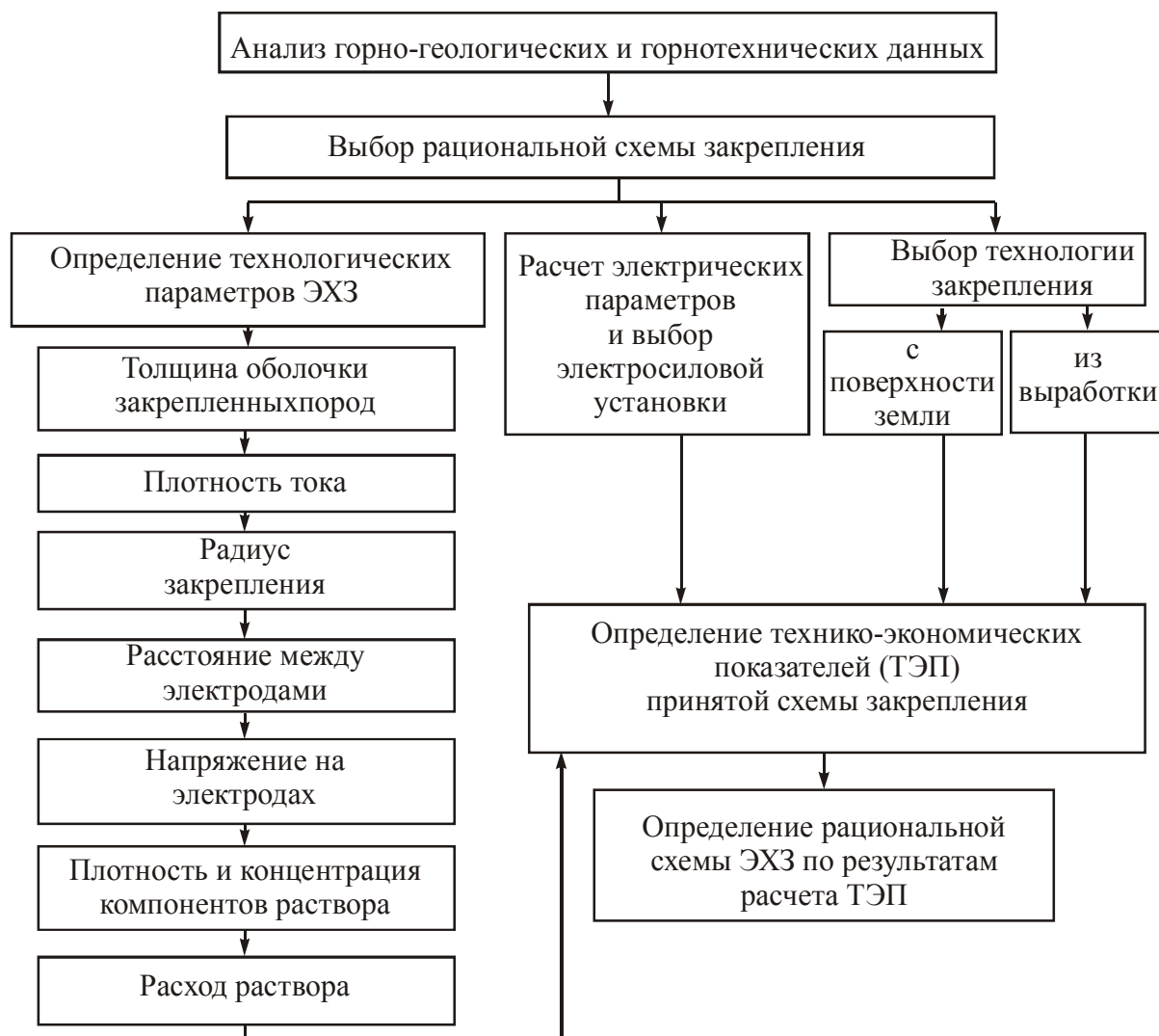
Рисунок 3 – Алгоритм проектирования ЭХЗ
