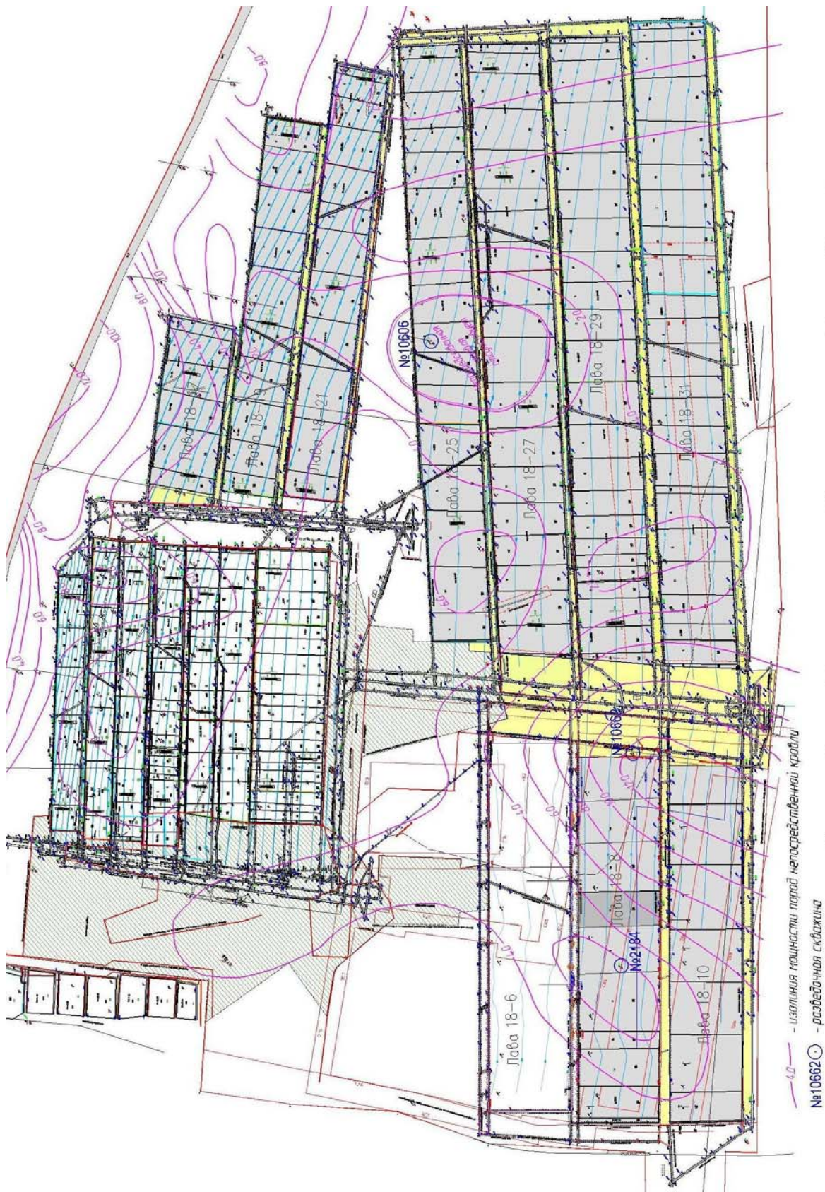
Рисунок 1 – Шахта Польшаевская. План горных работ по пласту Толмачевский
