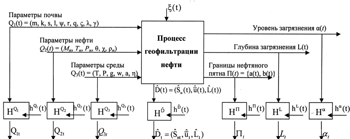
Рисунок 1 – Схема многомерного стохастического процесса геофильтрации нефти в пористой среде
