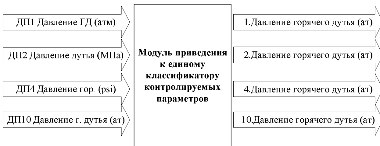
Рисунок 2 – Схема работы модуля приведения к единому классификатору контролируемых параметров
