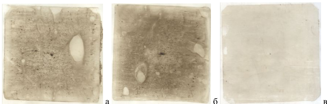
Рисунок 1 – Изображения серных отпечатков поперечных темплетов непрерывнолитой заготовок квадратного сечения в масштабе 1:5
