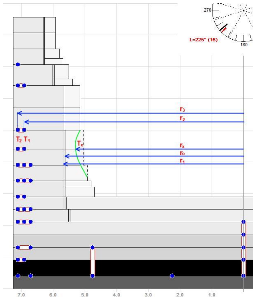
Рисунок 2 – К постановке задачи при разгаре кладки
